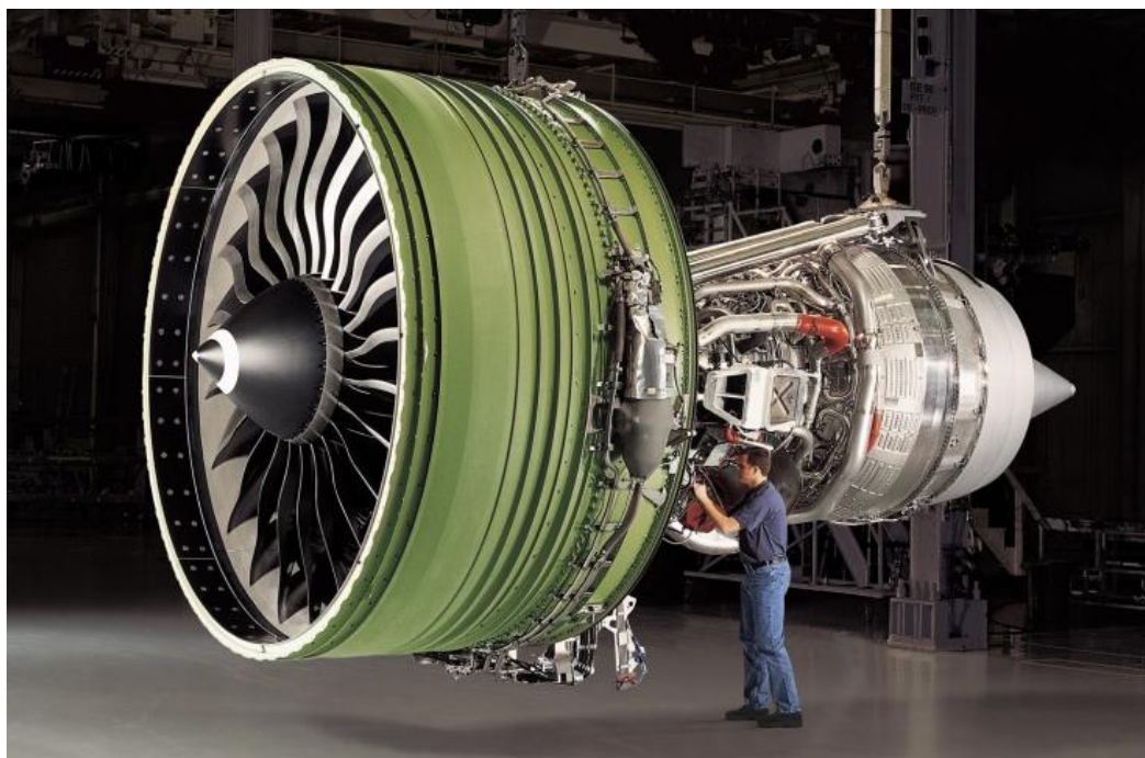
Slika 6.1. GE90-115B je najsnažniji motor na svijetu
