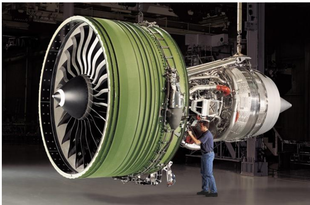
Slika 6.1. GE90-115B je najsnažniji motor na svijetu
