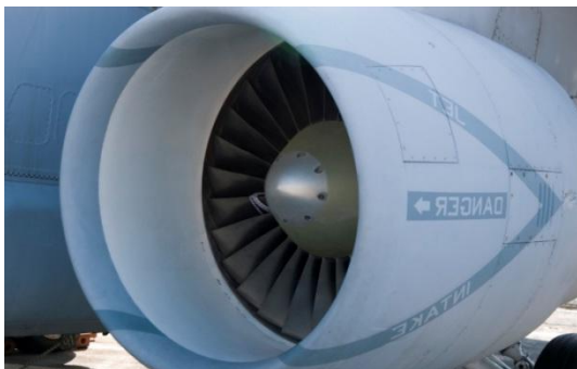
Slika 2.5. Tipičan izgled usisnika na turbo-ventilatorskom putničkom zrakoplovu
