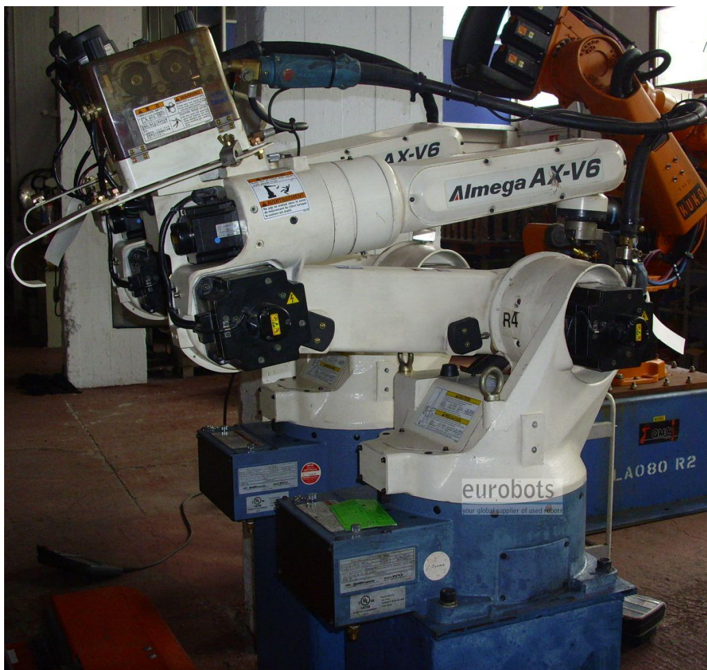
Slika 4. Almega AX V6 robot korišten za MAG zavarivanje
