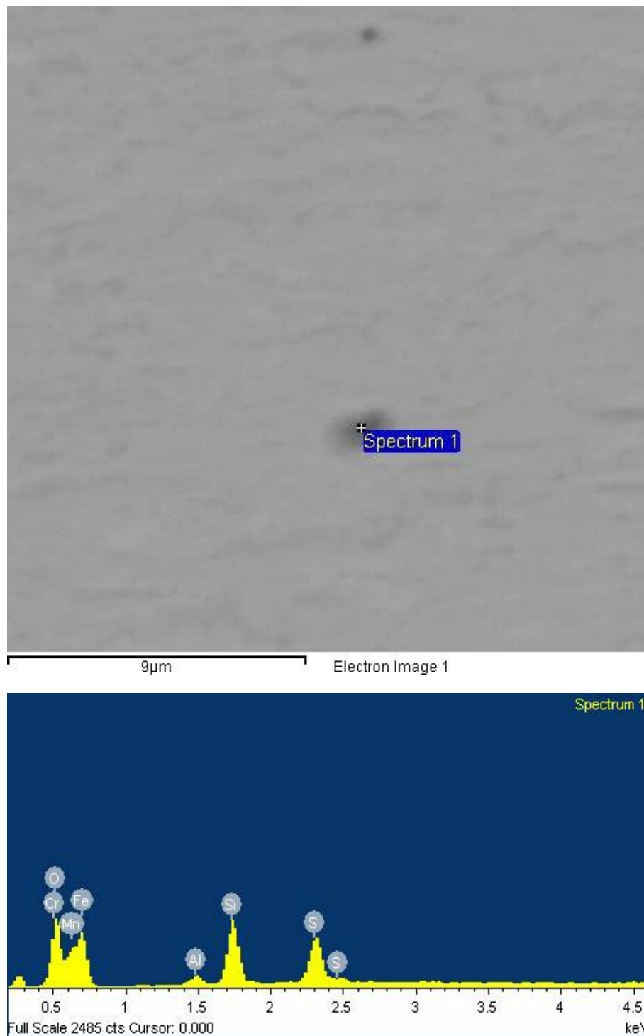
Slika 47. Točkasta EDS analiza uključine u području zavara za uzorak 4
