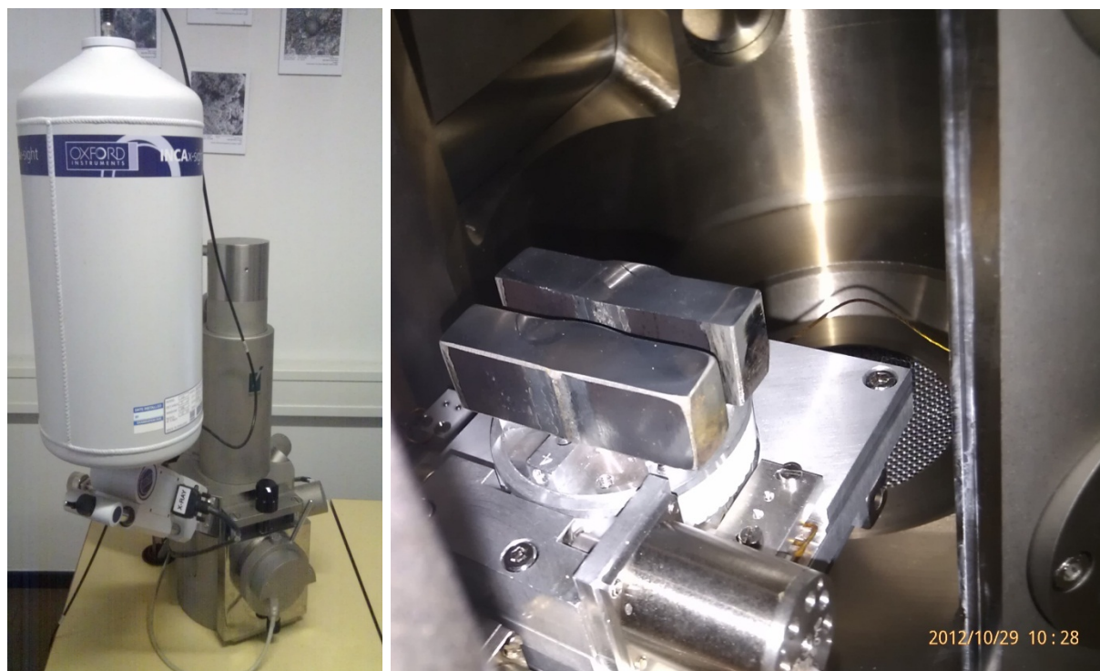
Slika 9. Skenirajući elektronski mikroskop (SEM) – lijevo Vakuumska komora SEM-a sa uzorcima za ispitivanje – desno
