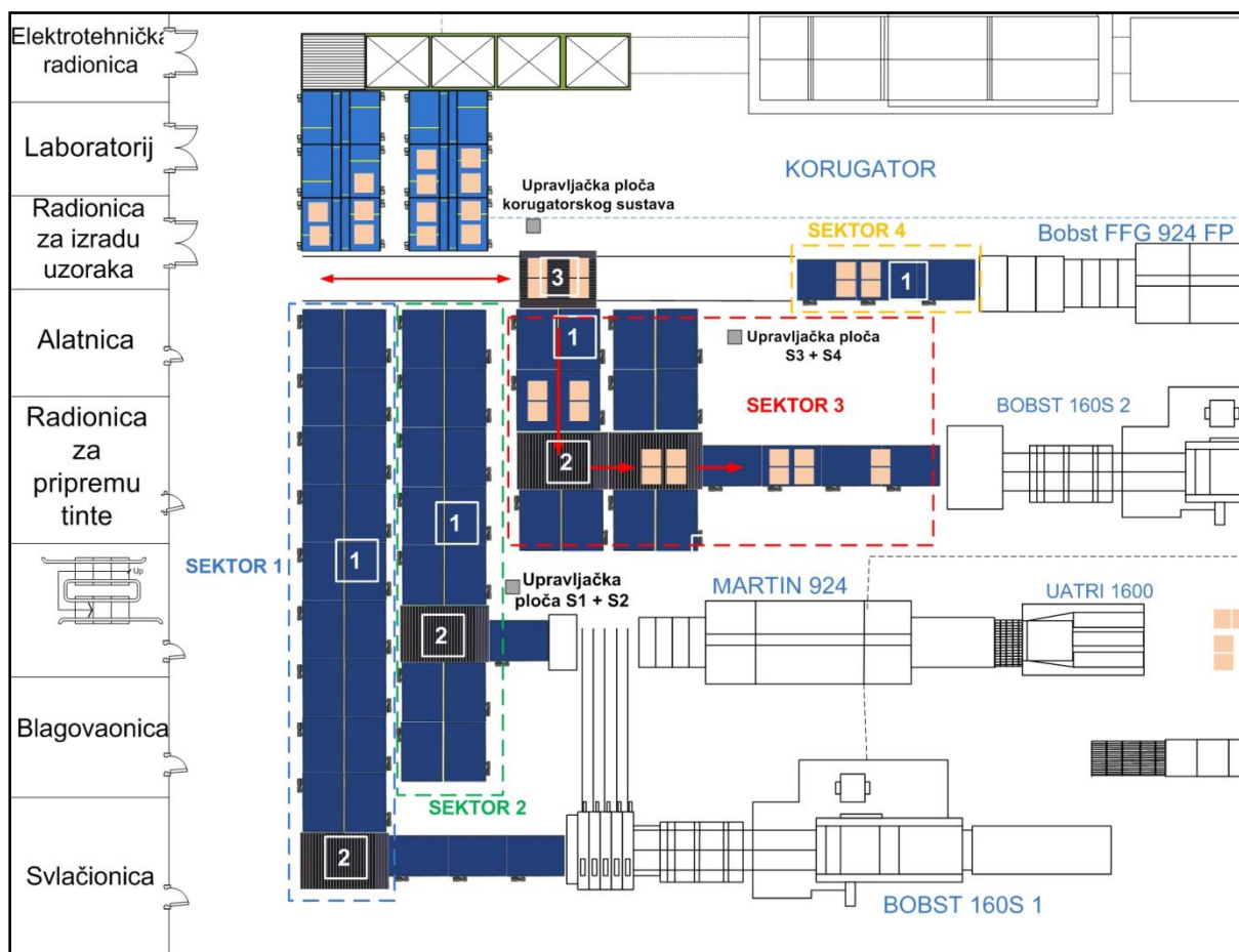
Slika 70. Koncept 1 – transport trakastim konvejerom
