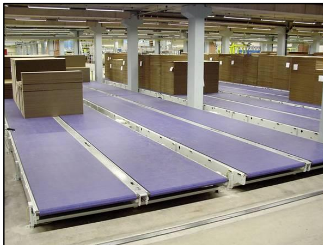
Slika 62. Primjer trakastog prijelaznog sustava [14]
