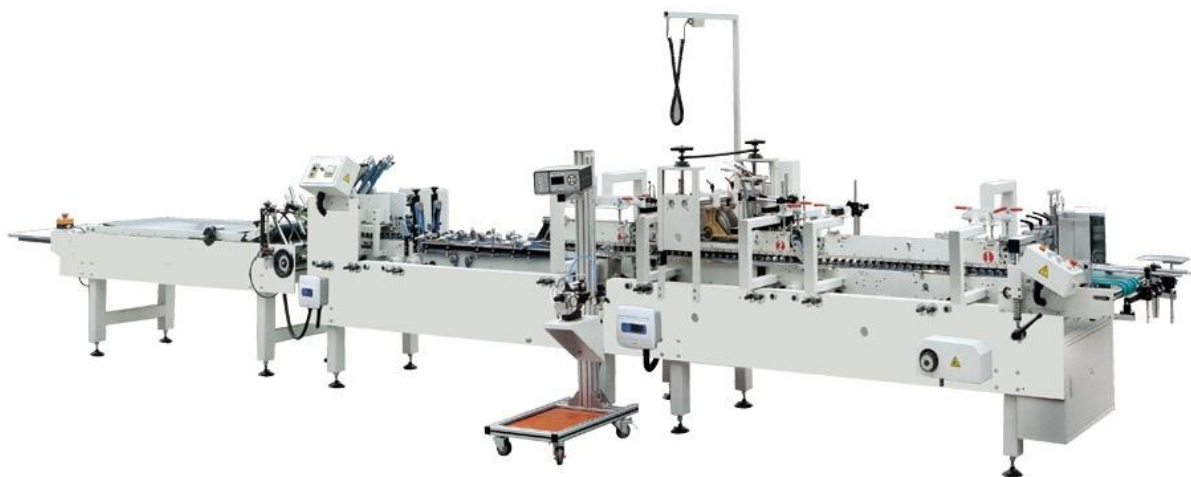
Slika 47. Uređaj za presavijanje i lijepljenje
