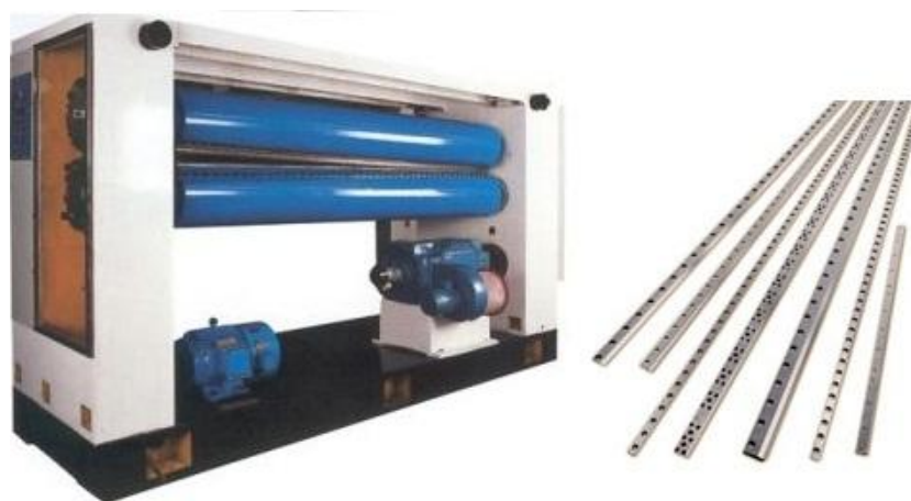
Slika 38. Uređaj rotary shear s noževima
