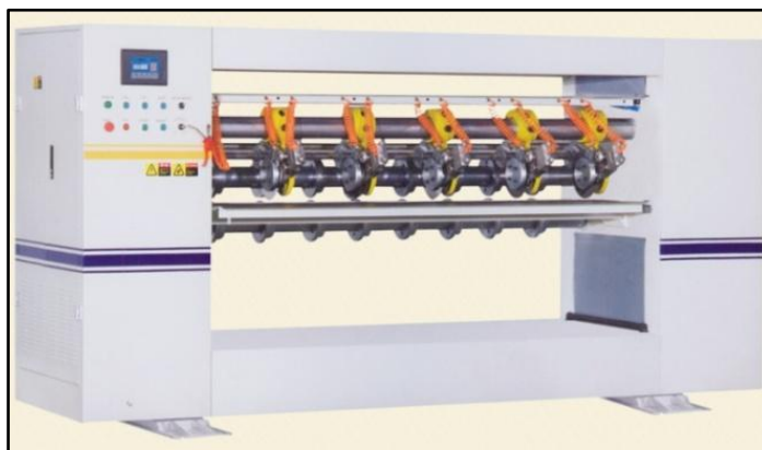
Slika 36. Slitter – scoring uređaj
