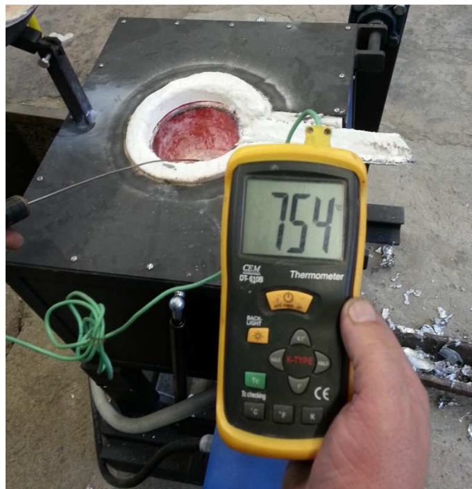
Slika 36. Mjerenje temperature prije lijevanja u kalup
