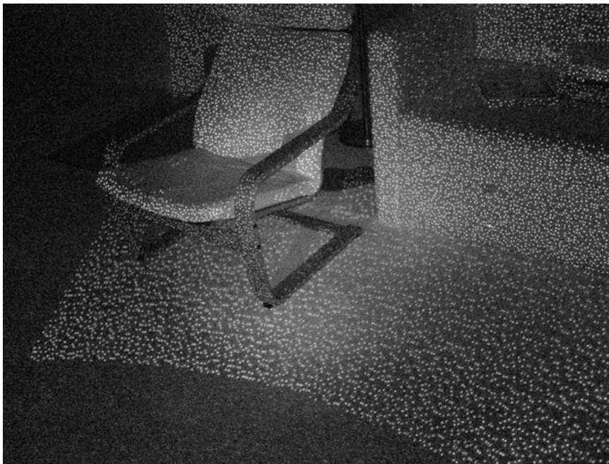
Slika 7 Mreža oku nevidljivih IR točaka projicirana u prostor
