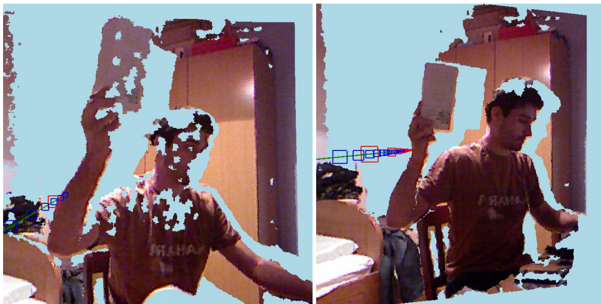
Slika 23 Utjecaj preklapanja mreža infracrvenih točaka dvaju Kinect-a na dobivenu sliku: lijevo sa preklapanjem, desno bez preklapanja
