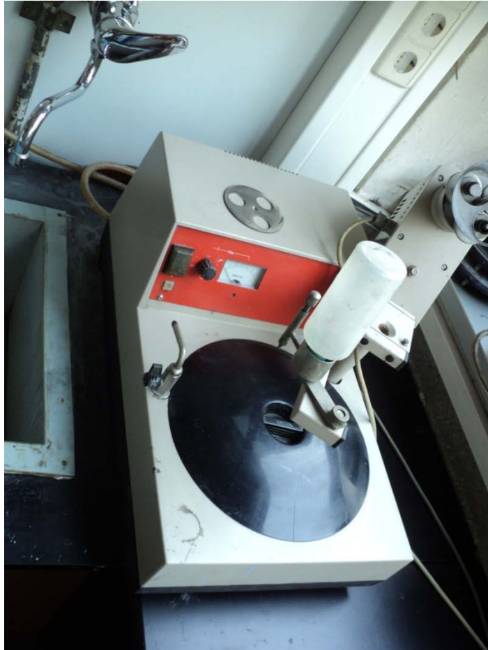
Slika 50. Uređaj za poliranje
