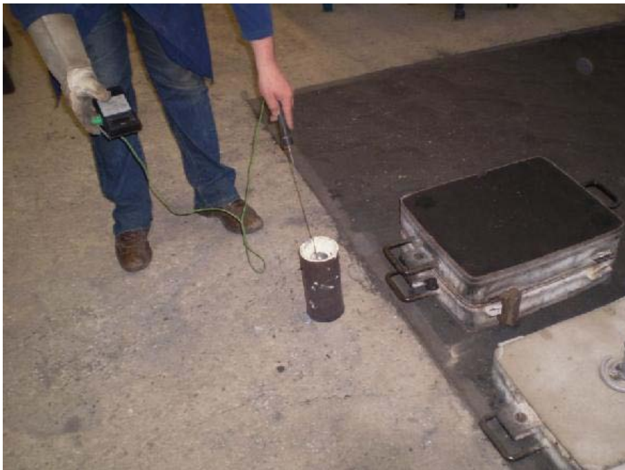
Slika 36. Mjerenje temperature taljevine neposredno prije ulijevanja u kalup
