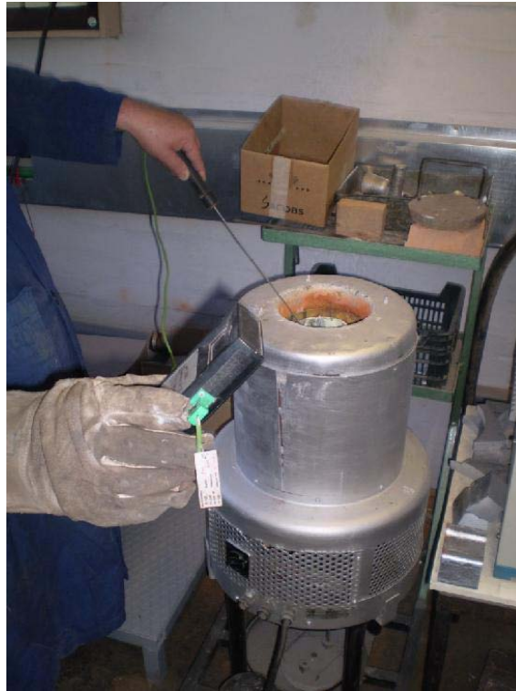
Slika 35. Mjerenje temperature pirometrom
