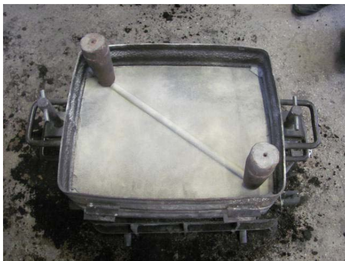
Slika 27. Postavljanje modela spusta i pojila
