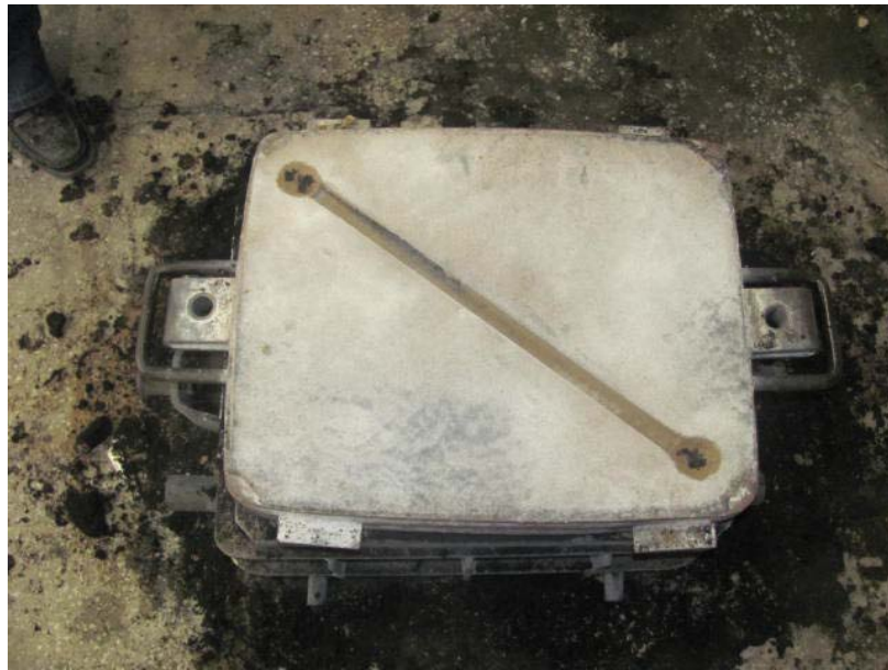
Slika 29. Donjak nakon oblikovanja spusta
