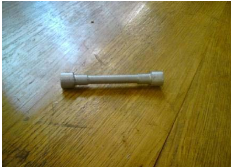
Slika 56. Epruveta za vlačna ispitivanja na kidalici
