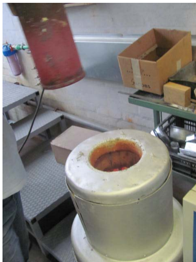
Slika 38. Umetanje lonca u elektrootpornu peč
