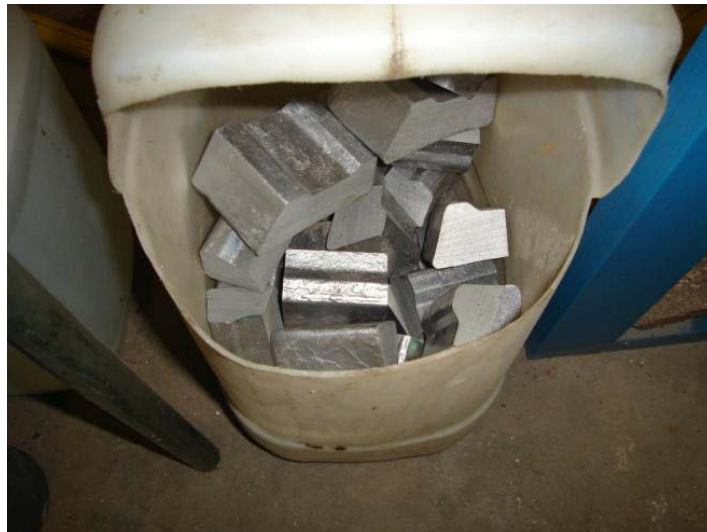
Slika 33. Blokovi AlSi12 legure
