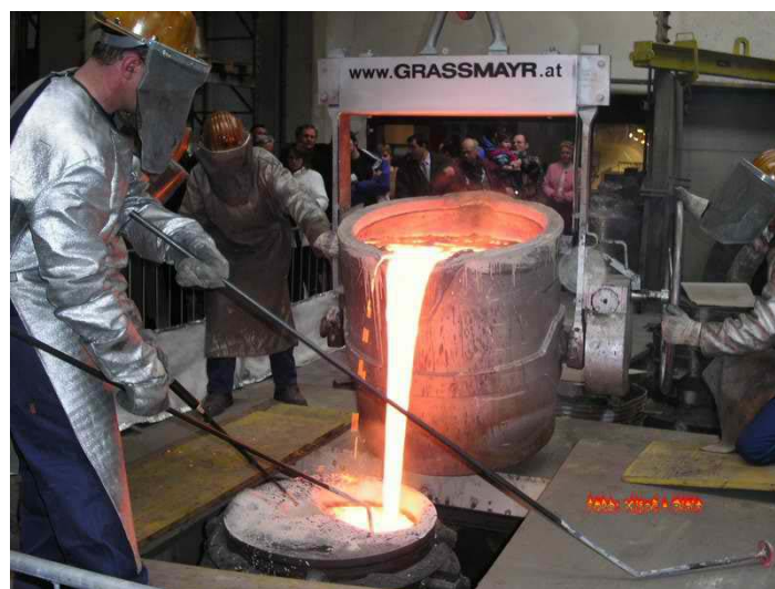
Slika 1. Lijevanje metala u kalup [3]
