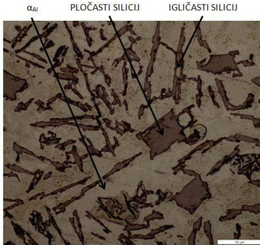
Slika 63. Mikrostruktura AlSi12 legure (povećanje 500x)
