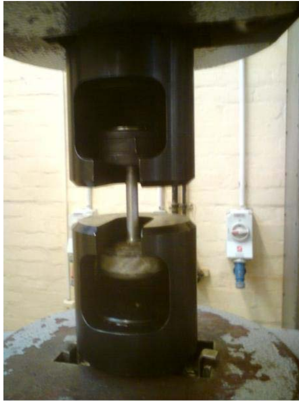
Slika 59. Pozicija epruvete na kidalici
