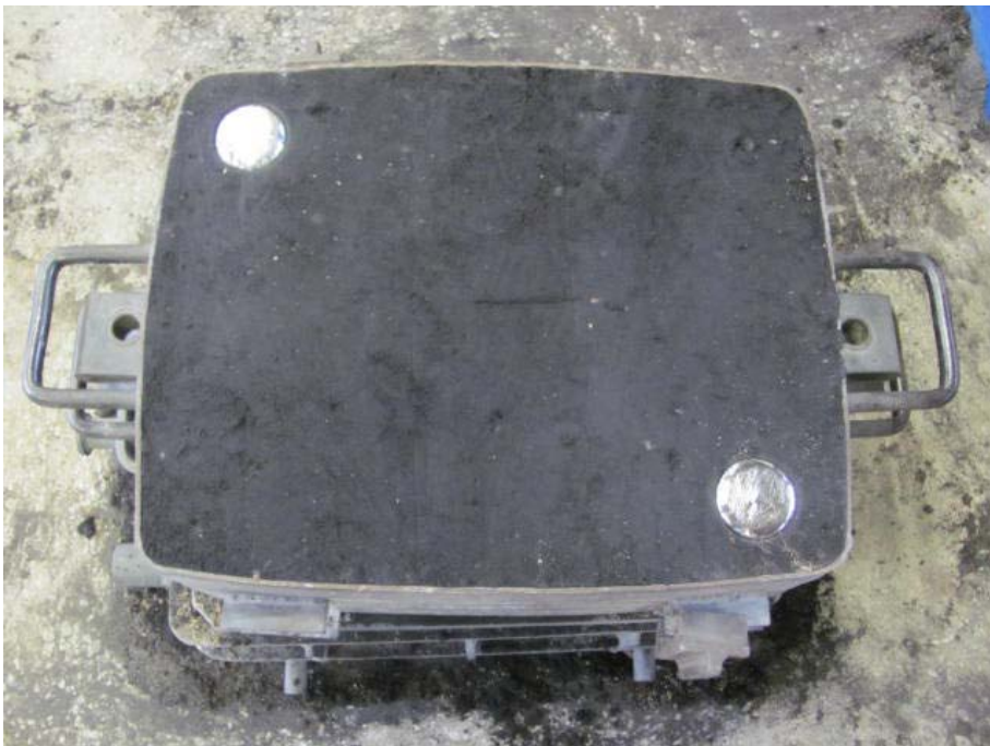
Slika 41. Kalup ispunjen taljevinom
