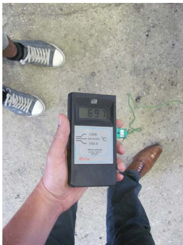
Slika 39. Očitavanje temperature taljevine
