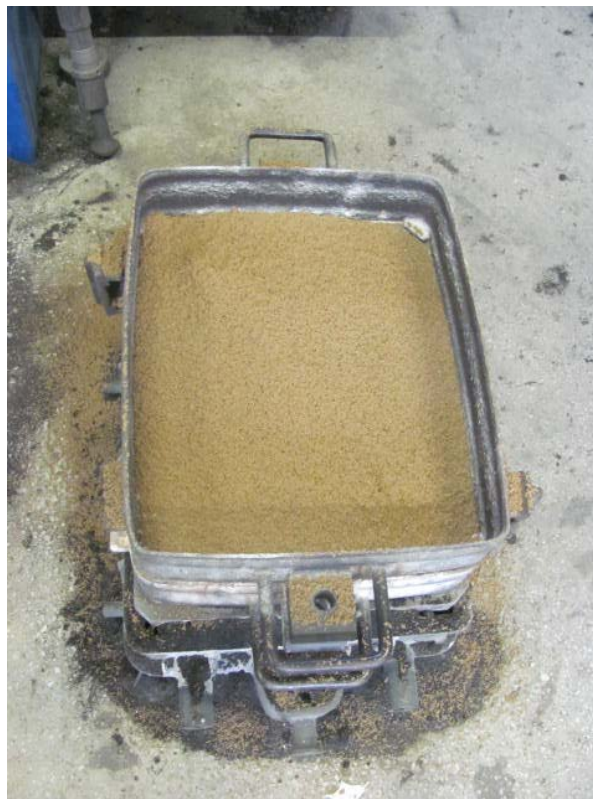
Slika 24. Nasipavanje modelnog pijeska
