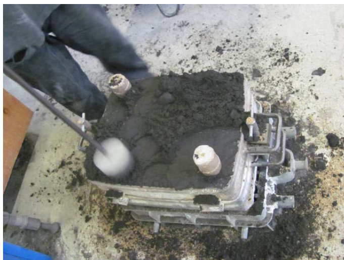
Slika 28. Sabijanje kalupne mješavine gornjaka
