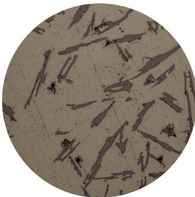
Slika 57. Mikrostruktura AlSi12 legure cijepljene AlTi10 predlegurom i otplinjena Nitralom C19 (povećanje 500X)
