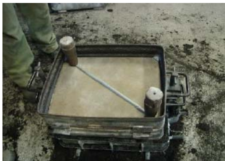
Slika 21. Postavljanje modela spusta i pojila
