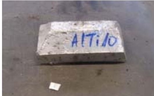
Slika 31. Predlegura AlTi10 za usitnjavanje zrna
