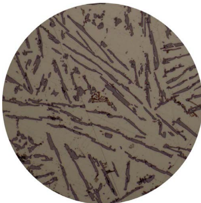
Slika 55. Mikrostruktura neobrađene AISi12 legure otplinjene Nitralom C19 (povećanje 500x)
