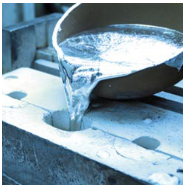
Slika 5. Uljevanje taljevine u stalni kalup [7]
