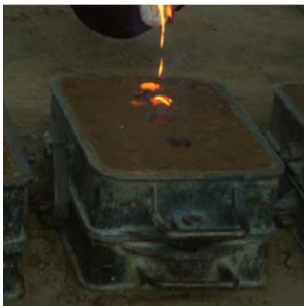
Slika 4. Ulijevanje taljevine u jednokratni pješčani kalup [6]
