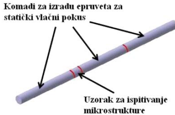
Slika 39. Izdvajanje uzoraka i komada odljevka
