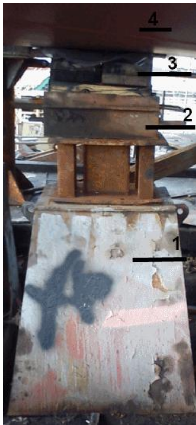
Slika 7. Pješčana potklada 1- čelična baza, 2- pješčana kutija, 3- meko drvo, 4- trup broda
