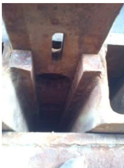
Slika 8. Čelično dno pješčane kutije sa rupama za pijesak
