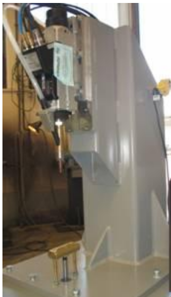
Slika 5.6 RM2 - EO zavarivanje vijaka2
