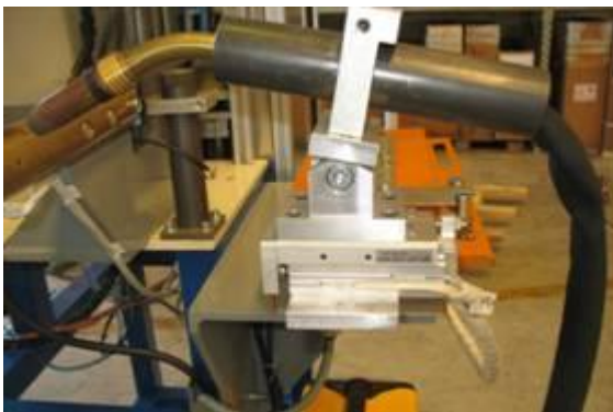
Slika 5.10 RM3 - strojni gorionik, ručno hlađen
