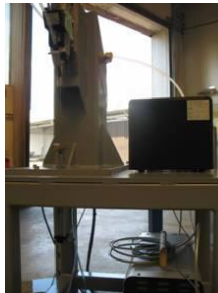
Slika 5.7 RM2 - EO zavarivanje vijaka (pneumatski cilindar)
