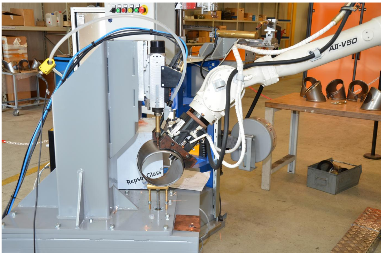
Slika 6.2 Elektrootporno zavarivanje stojećih vijaka
