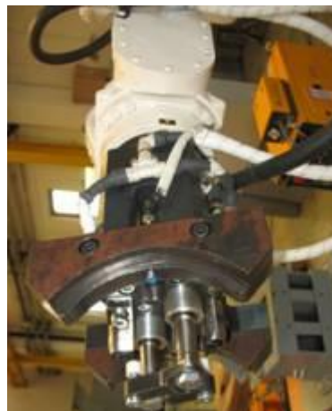
Slika 5.3 Pneumatska stezna robotska ruka (644561MKBTF-20R SMC)
