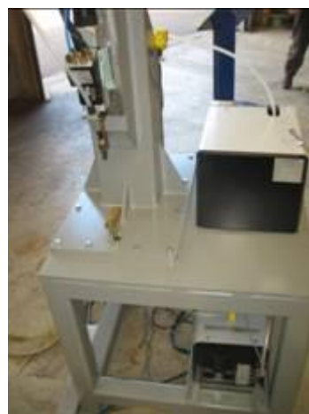
Slika 5.5 RM2 - EO zavarivanje vijaka
