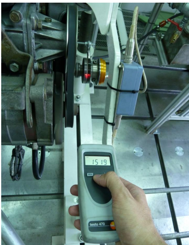
Slika 9.15. Mjerenje brzine vrtnje motora laserom
