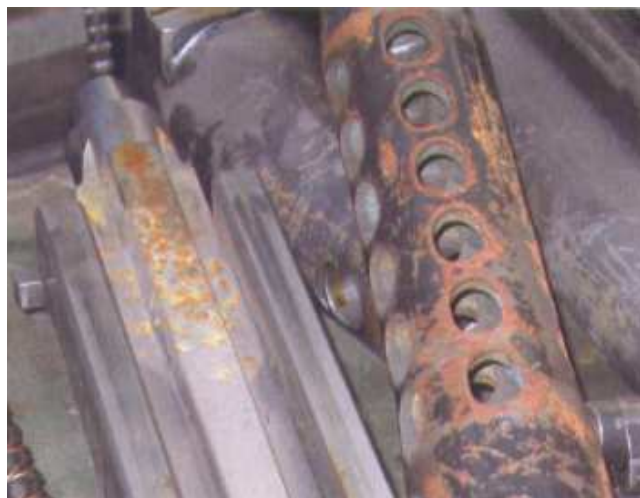
Slika 5.3. Korozija dijelova oružja kao posljedica neprovođenja temeljnog održavanja[16]
