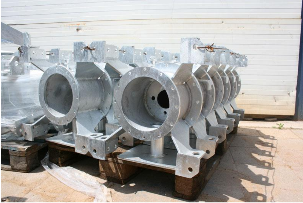
Slika 21. Kotlovi za mjerne transformatore [S21]
