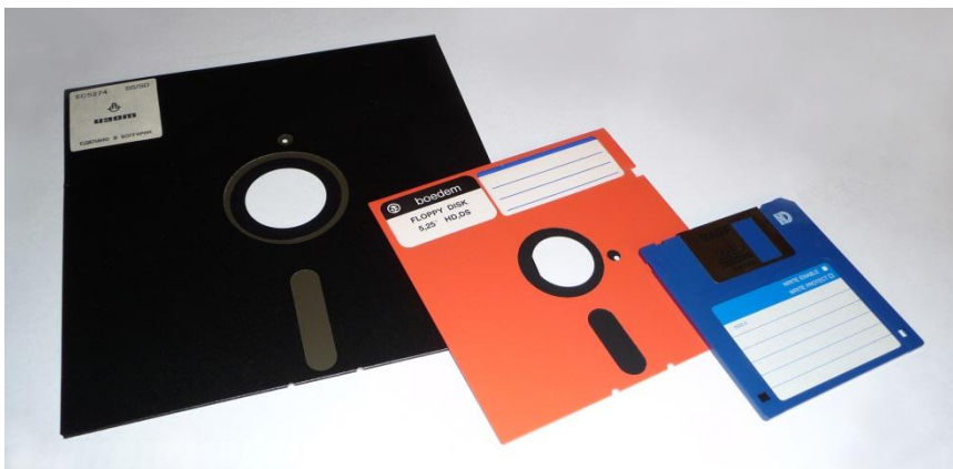
Slika 10. Primjer Poka yoke: disketa [S10]
