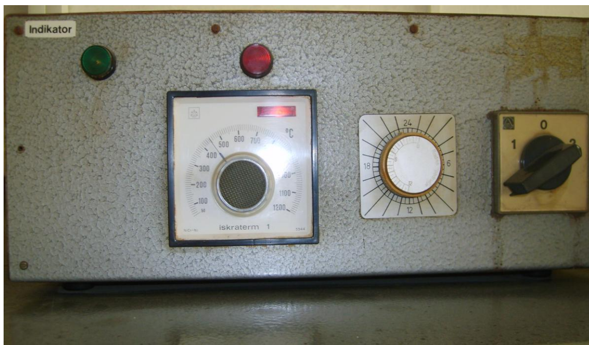
Slika 24. : Električna laboratorijska peć zagrijana na 450 °C
