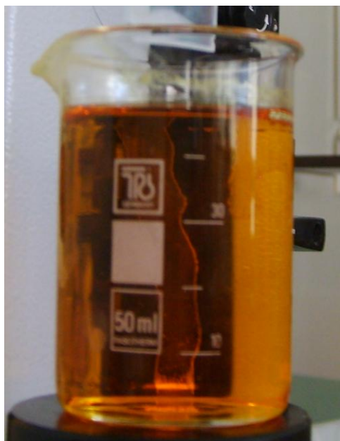
Slika 13. Priređeni sol za uranjanje
