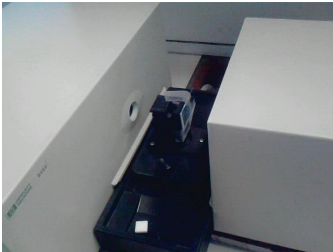
Slika 27. : Uzorak pripremljen za određivanje transmitancije
