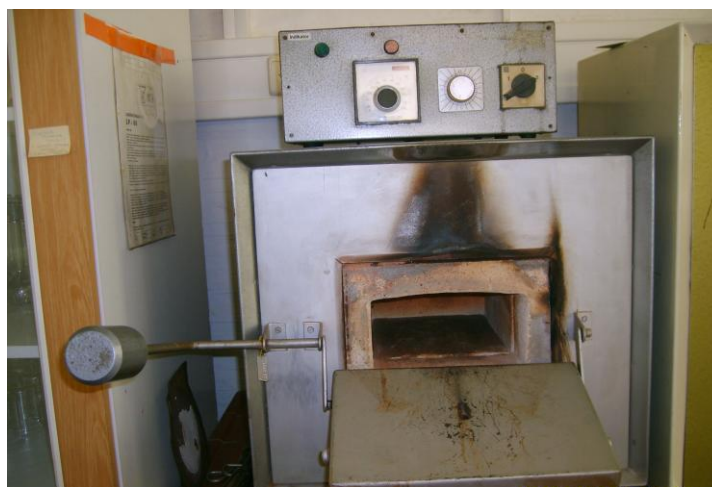
Slika 22. : Električna laboratorijska peć
