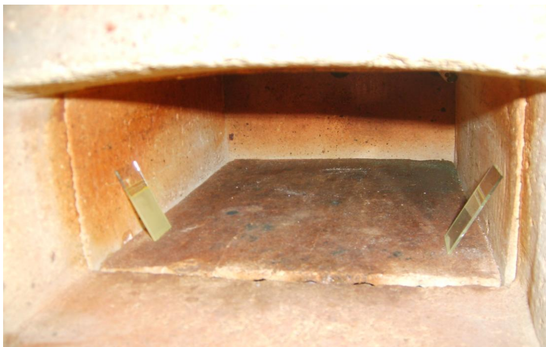
Slika 23.: Uzorci u peći pripremljeni za kalciniranje
