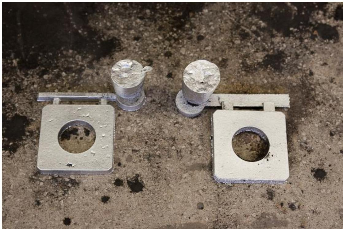
Slika 46. Prikaz odljevka sa uljevnim sustavima (lijevo-tlačni, desno-semitlačni)
