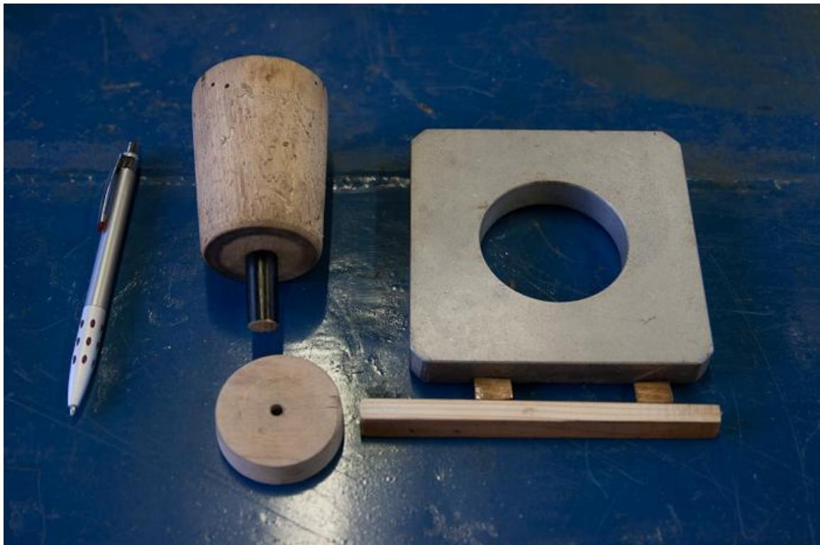
Slika 17. Model tlačnog uljevnog sustava izrađen od drva
