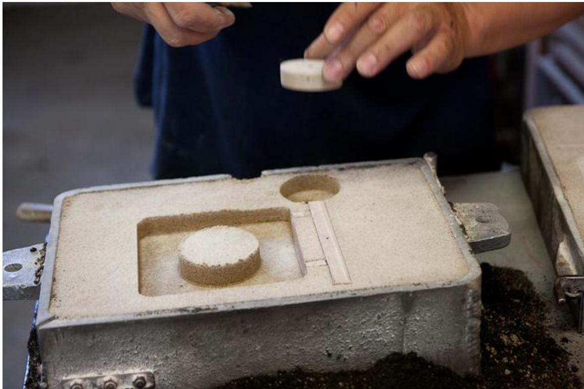
**Slika 32. Izdvajanje drvenih modela iz kalupa**
