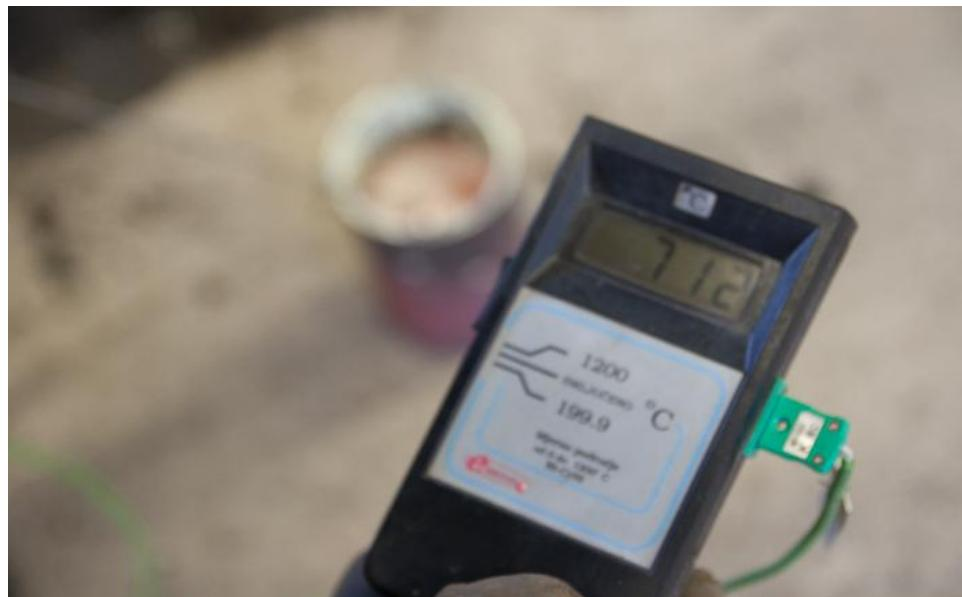
**Slika 37. Mjerenje temperature taljevine**
