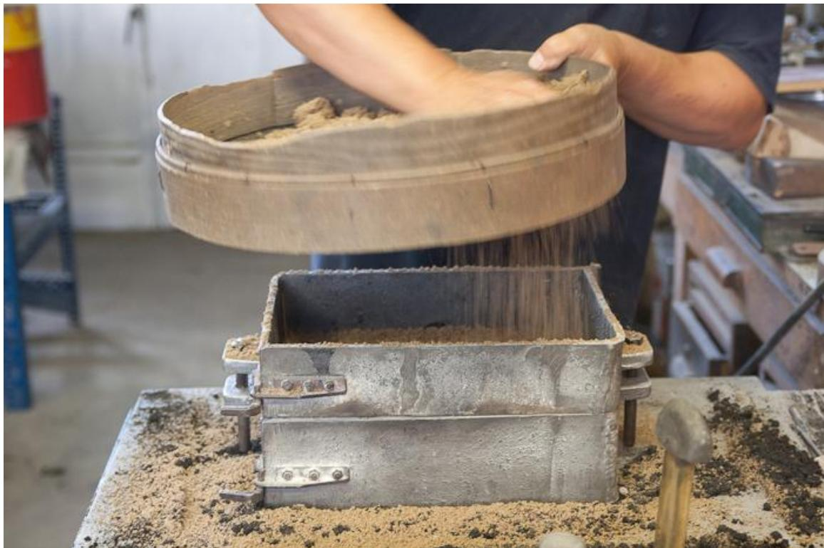
**Slika 27. Nasipavanje donjeg dijela kalupa modelnim pijeskom**
