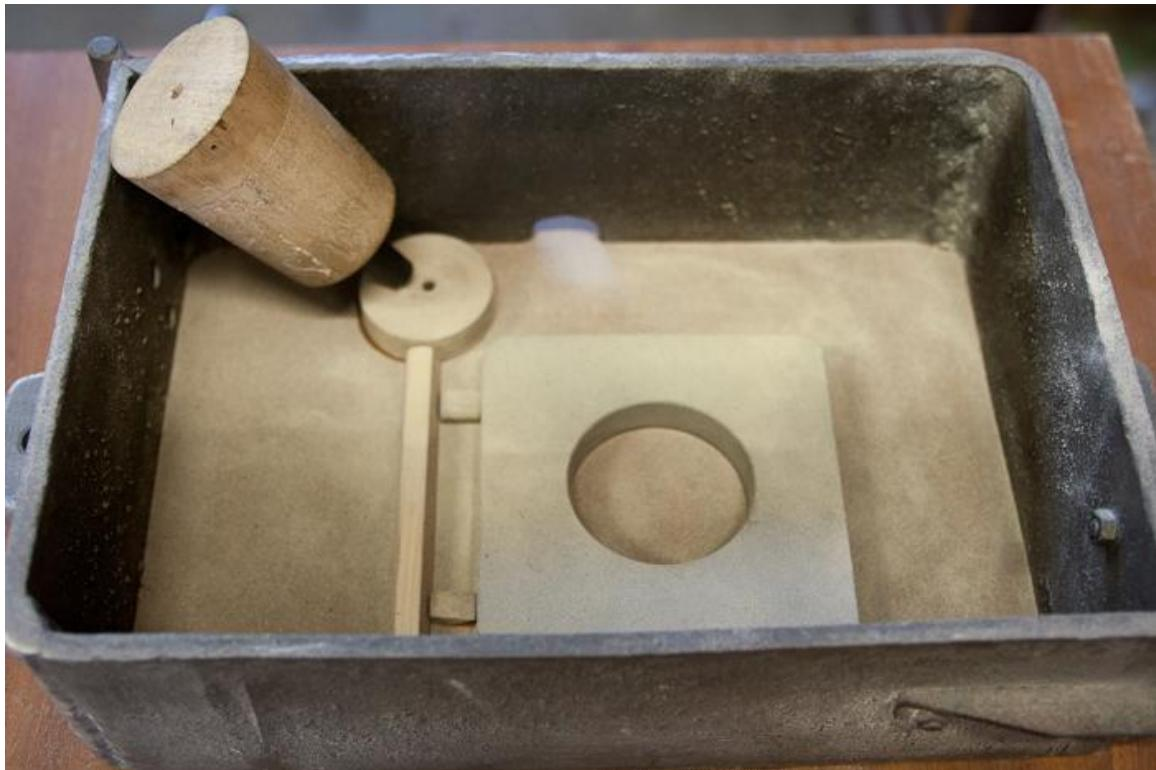
**Slika 18. Pozicioniranje drvenog modela u gornjak (dimenzija 300x200x90mm)**
