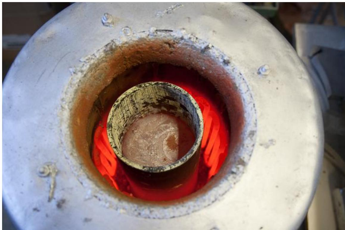
Slika 36. Taljenje aluminija u peći pri  $730^{\circ}\text{C}$
