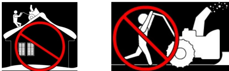
Slika 31. Neke mjere sigurnosti pri upotrebi stroja za čišćenje snijega i leda [21]
