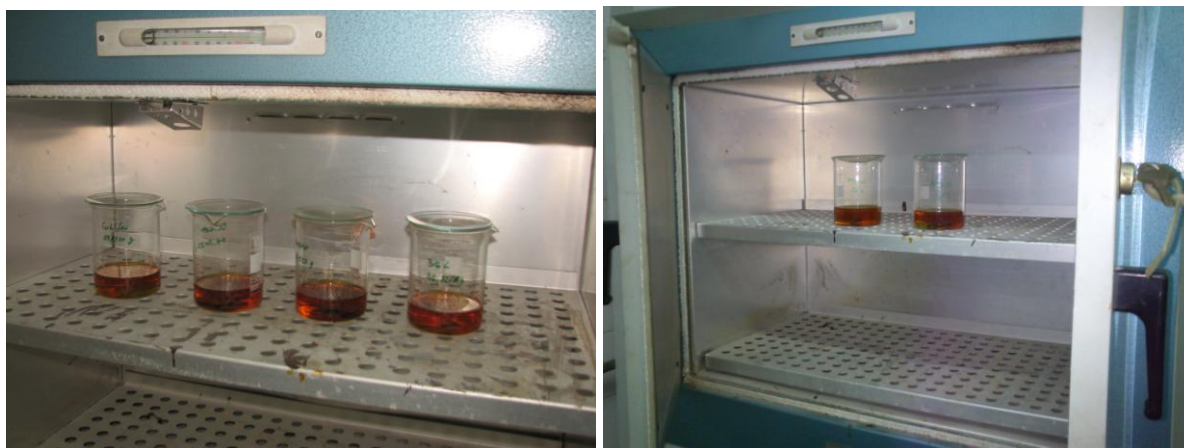
Slika 56. Uzorci u toplinskoj komori spremni za ispitivanje
