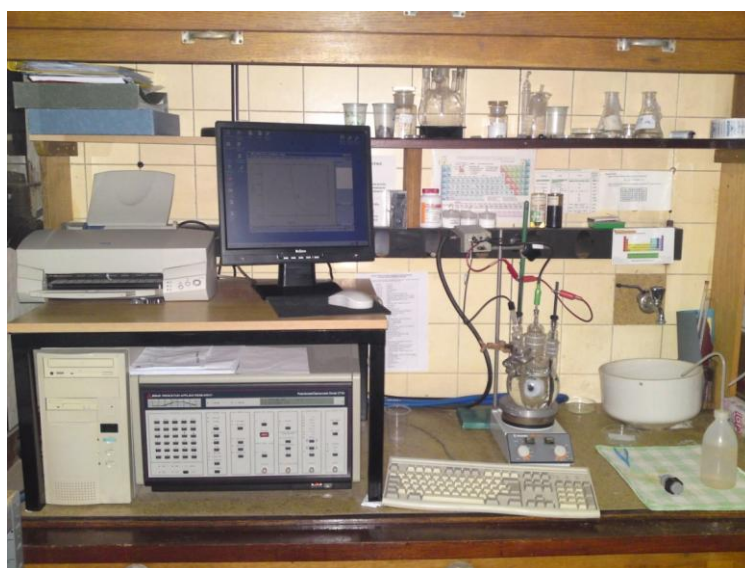
Slika 25. Oprema za DC ispitivanja
