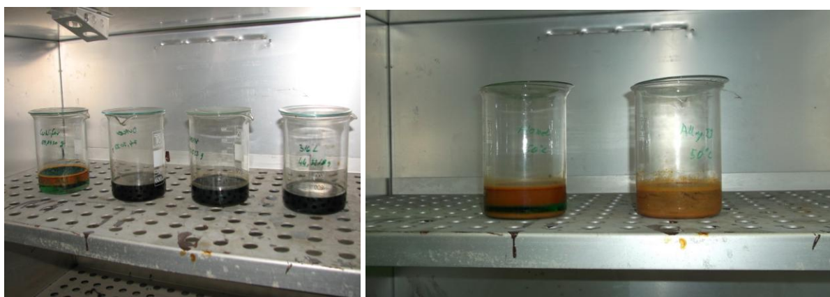
Slika 61. Uzorci nakon 24 sata u otopini \text{FeCl}_3 pri temperaturi 50\text{ }^\circ\text{C}
