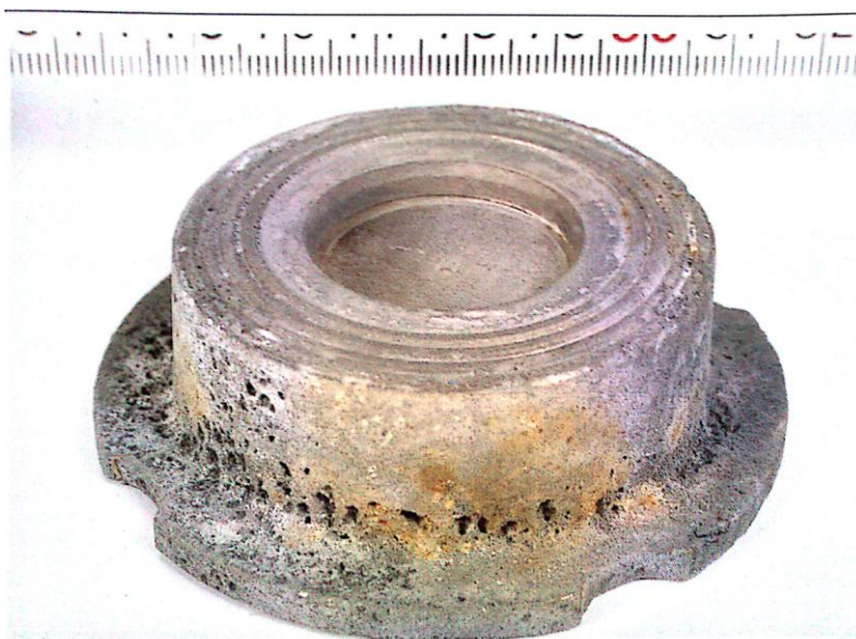
Slika 18. Oštećenje izazvano rupičastom korozijom pri povišenim temperaturama (slučaj 3) [13]
