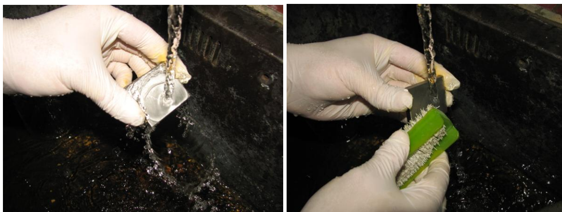
Slika 59. Čišćenje i četkanje uzoraka
