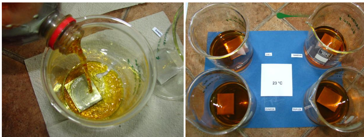
Slika 55. Uronjanje uzoraka u otopinu FeCl 3
