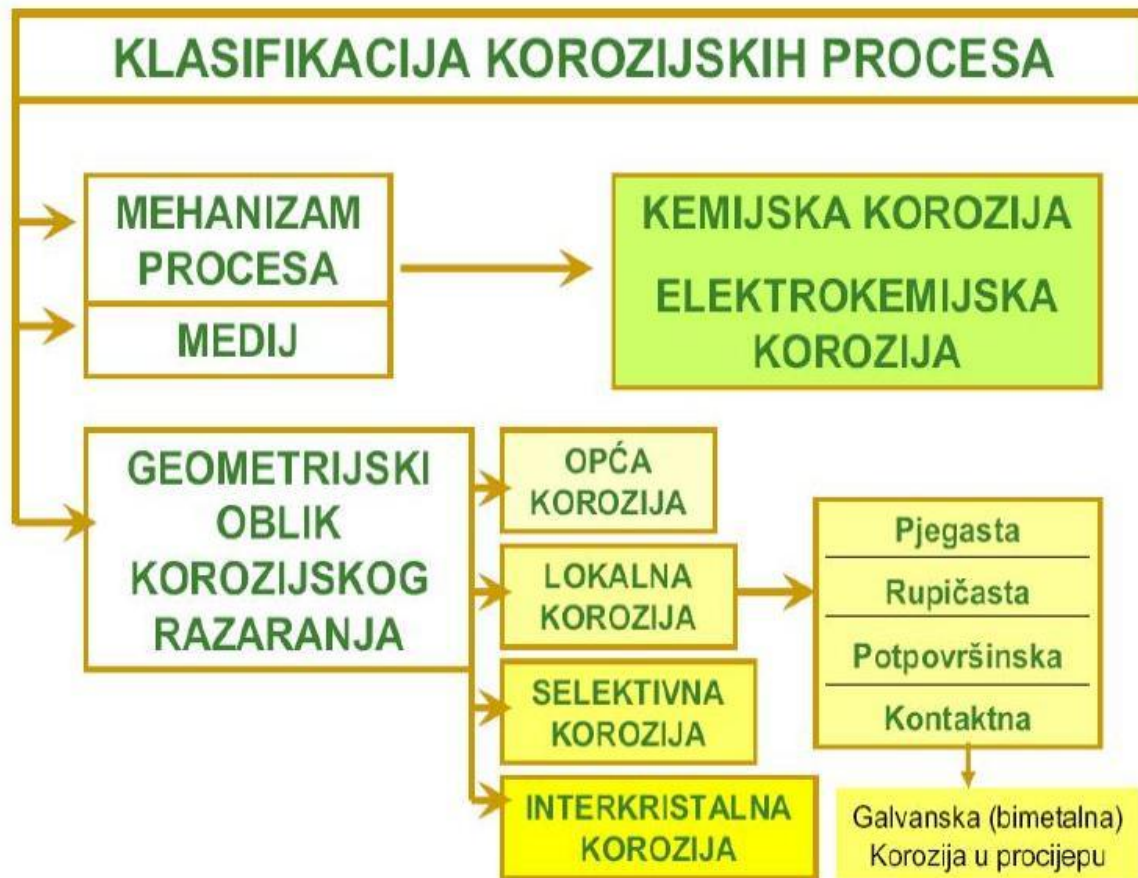
Slika 2. Klasifikacija korozijskih procesa [3]
