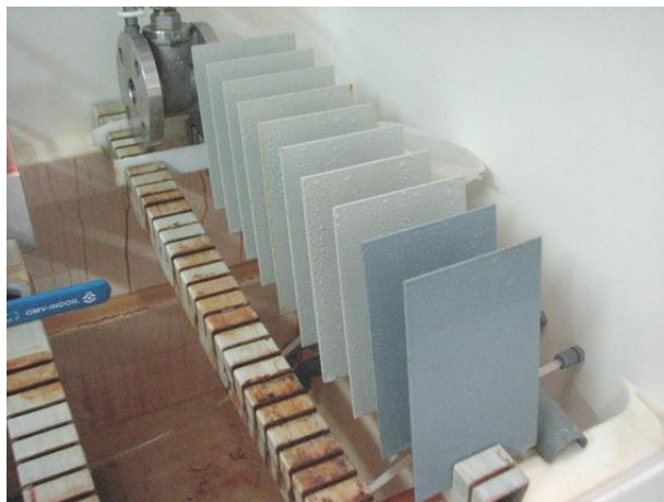
Slika 33. Slana komora Ascott, model S450 sa ispitnim uzorcima [10]
