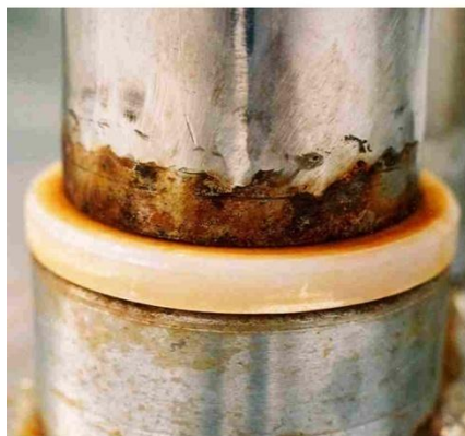
Slika 8. Korozija u procjepu [6]
