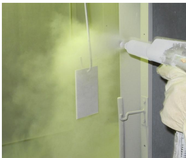
Slika 30. Prikaz elektrostatskog nanošenja praha na uzorak za ispitivanje u slanoj i vlažnoj komori [10]
