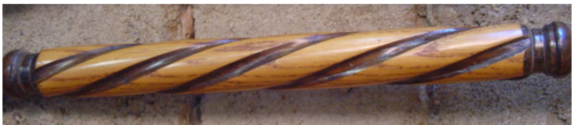
Slika 3.17 Primjena ortogonalnog okretnog glodanja kod izrade ukrasnih stupića
