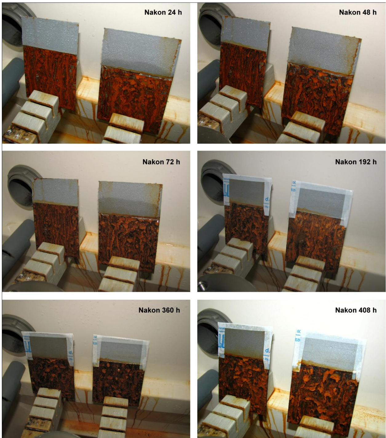
Slika 9.15. Izgled ispitivanih uzoraka u slanoj komori [15]
