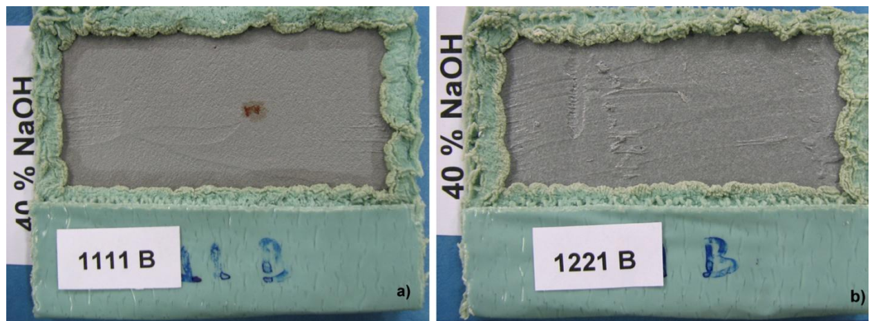
Slika 9.30. Oprani i osušeni uzorci nakon ispitivanja u lužnatoj otopini [15]
