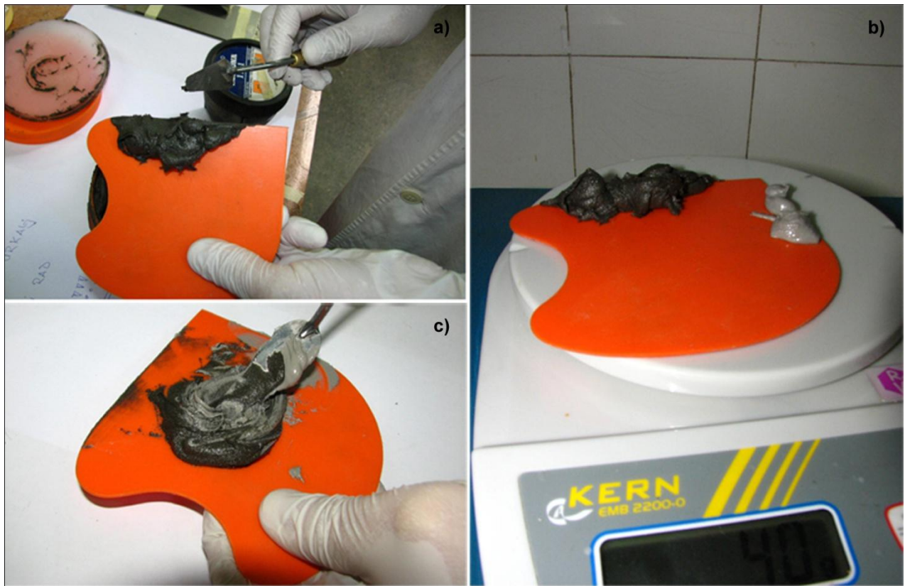
Slika 9.9. Priprema paste Super Metal prije nanošenja [15]
