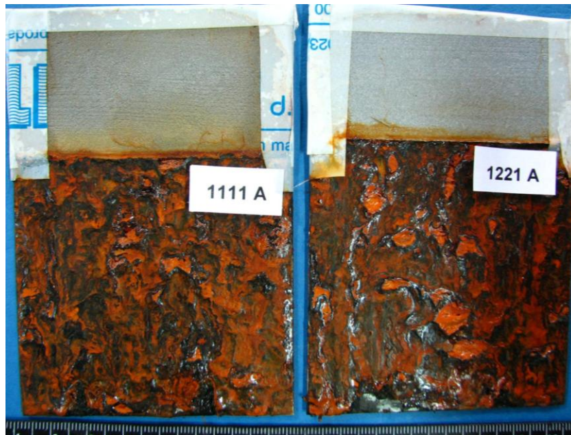
Slika 9.16. Ispitivani uzorci nakon 20 dana u slanoj komori [15]
