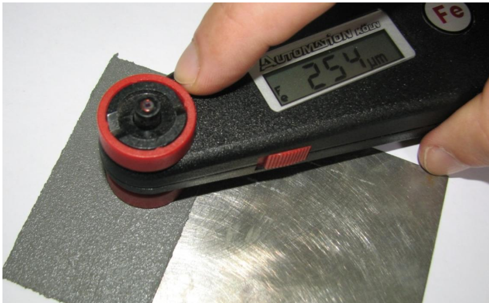
Slika 9.13. Mjerenje debljine prevlaka uređajem QuaNix 1500 [15]
