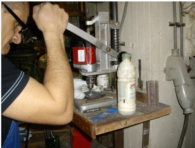
Slika 6.5. Bušenje rupe u kalupu koja omogućuje izlazak pjene u kalupa
