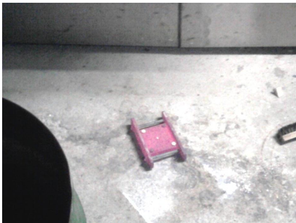
Slika 6.18.. Užareni kalup nakon vađenja iz peći
