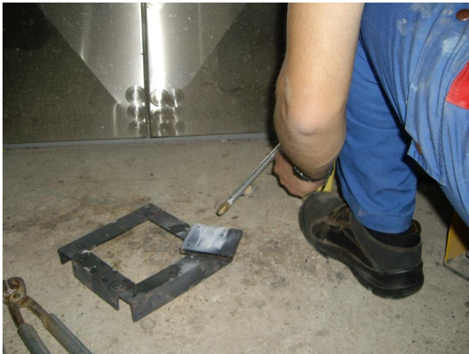
Slika 6.9. Nanošenje keramike na unutrašnju površinu kalupa
