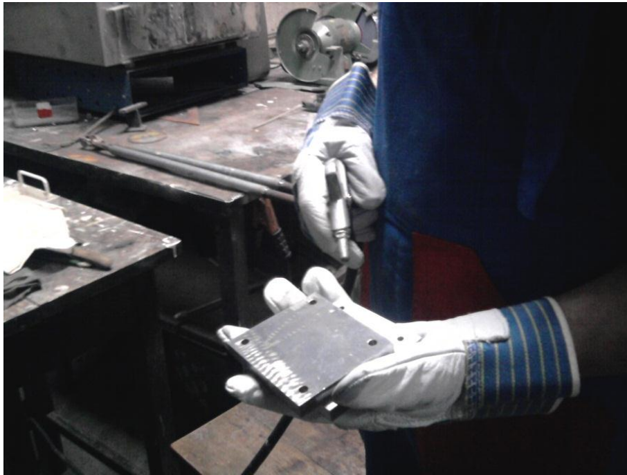
Slika 6.8. Propuhivanje kalupa zrakom iz kompresora
