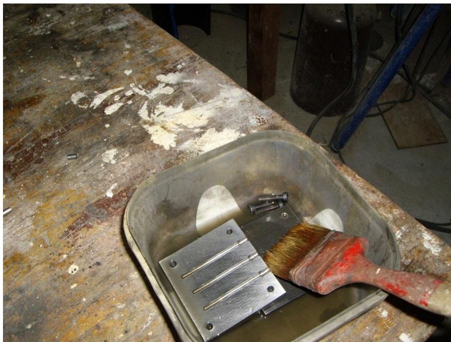
Slika 6.7. Čišćenje kalupa u benzinu
