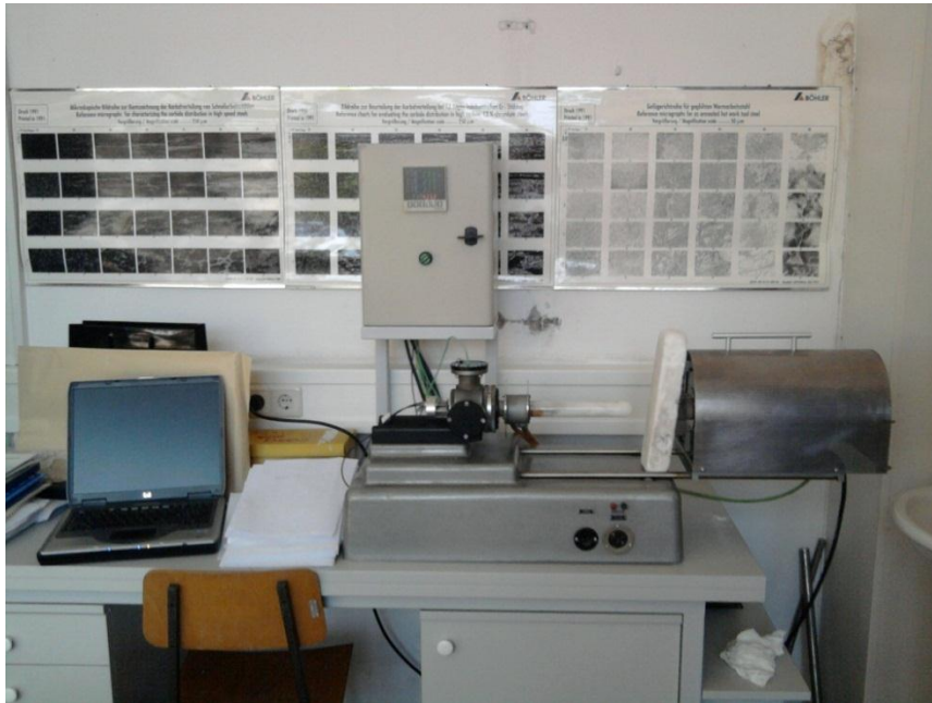
Slika 6.2. Dilatometar u radu
