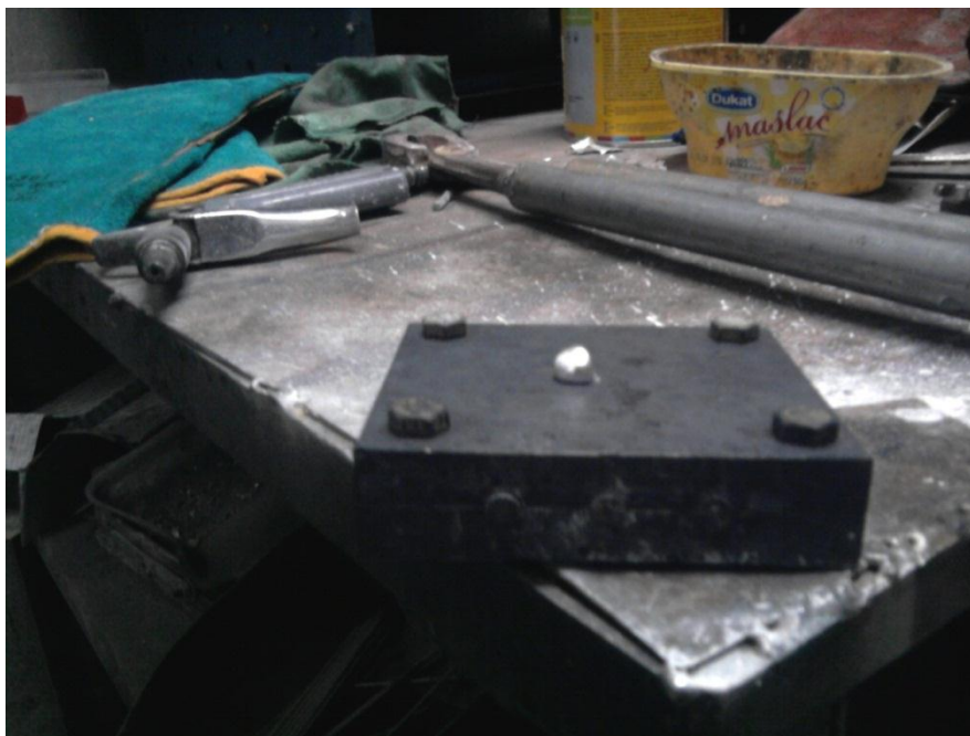
Slika 6.16. Ohlađeni kalup i kapljica pjene na površini kalupa prema kojoj se zna da je pjena gotova
