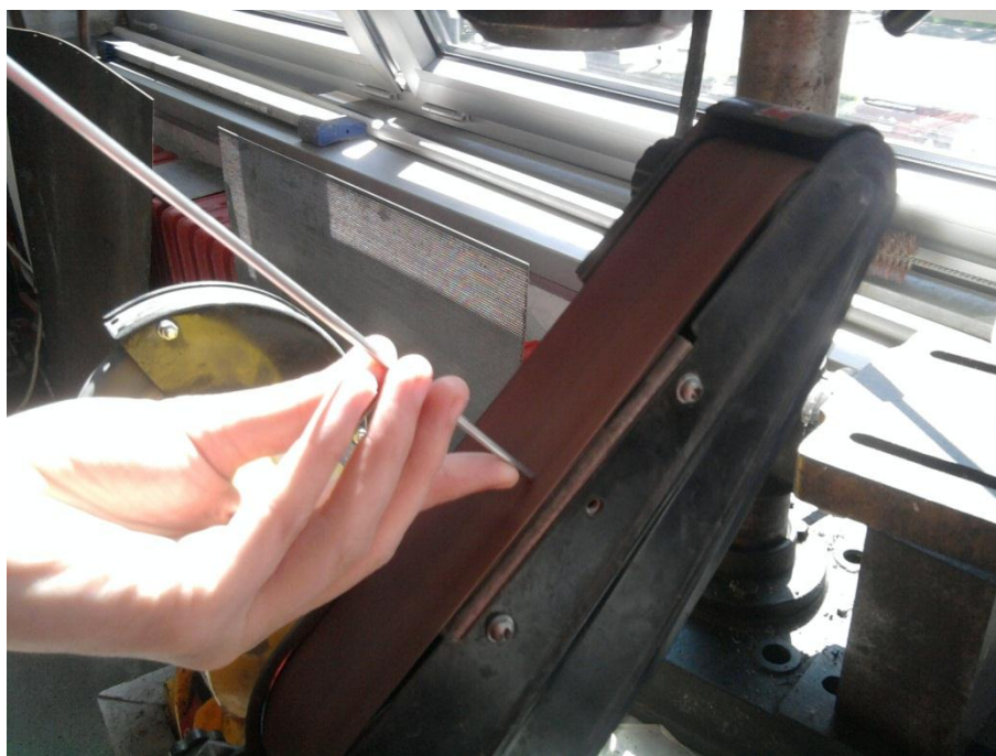
6.19. Brušenje ruba aluminijske žice
