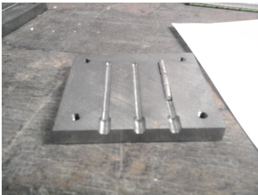
Slika 6.14. Postavljanje dijelova prekursora u kalup
