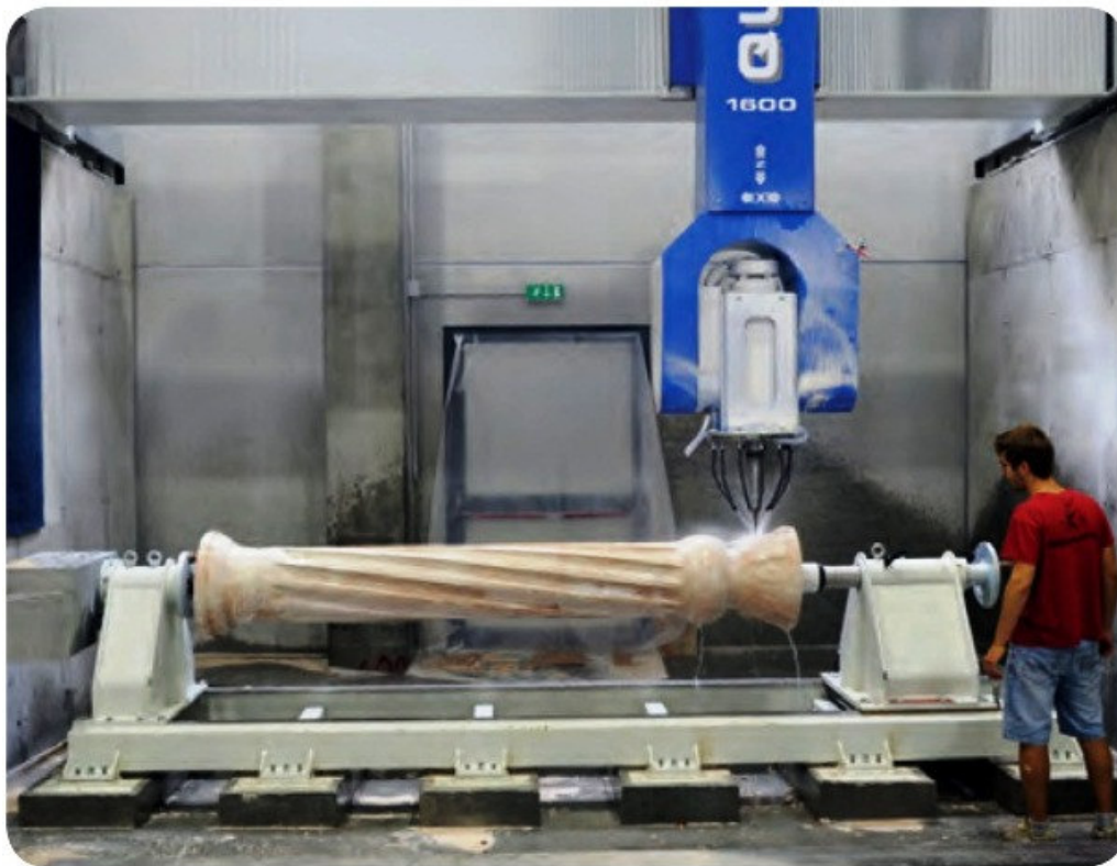
Slika 19. Okretno glodanje kamena na obradnom centru za glodanje kamena [4]
