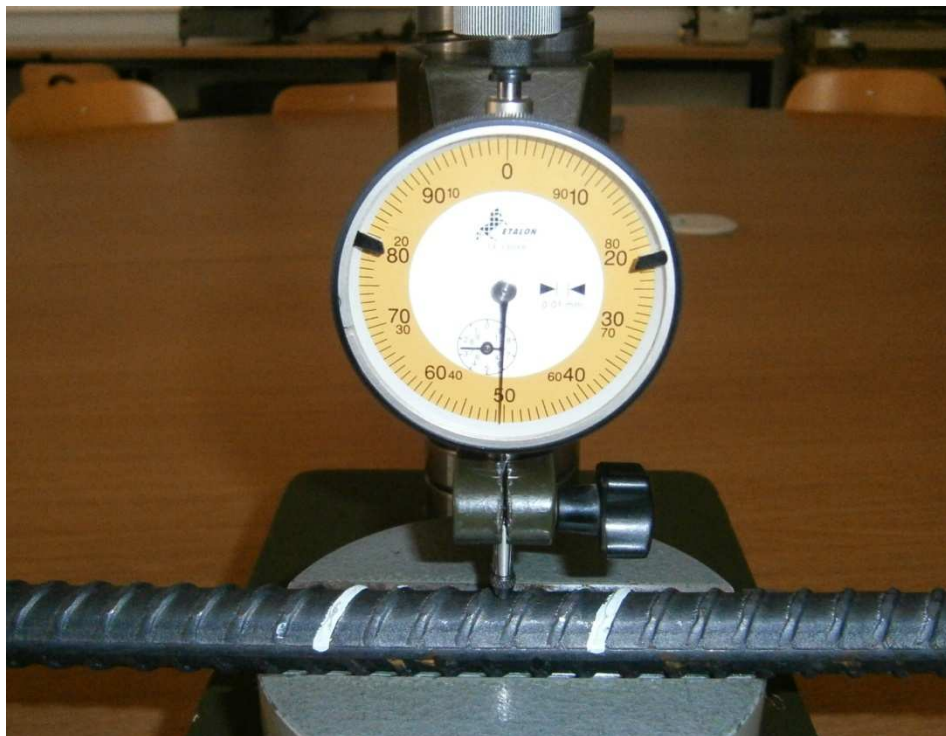
Slika 2.10. Mjerna ura pri mjerenju veličine a_m na uzorku 16 u LFSB-u.
