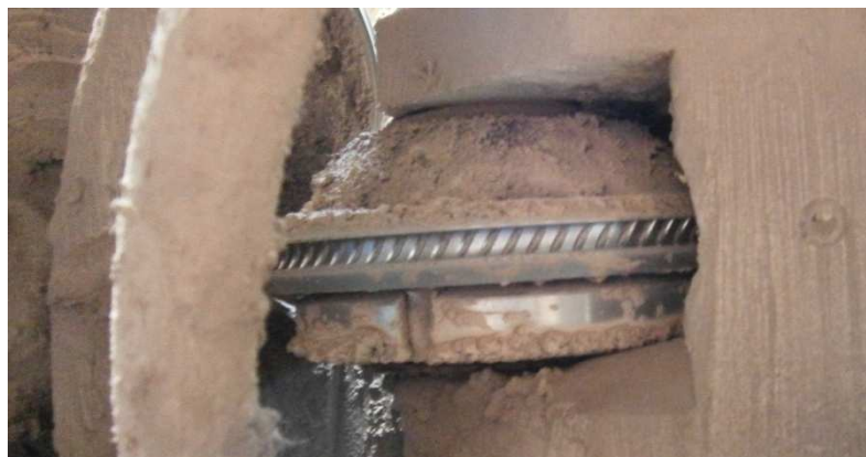
Slika 1.2. Valjak za orebrivanje žice detalj iz stroja za orebrivanje, pogon tvrtke ARMKO.
