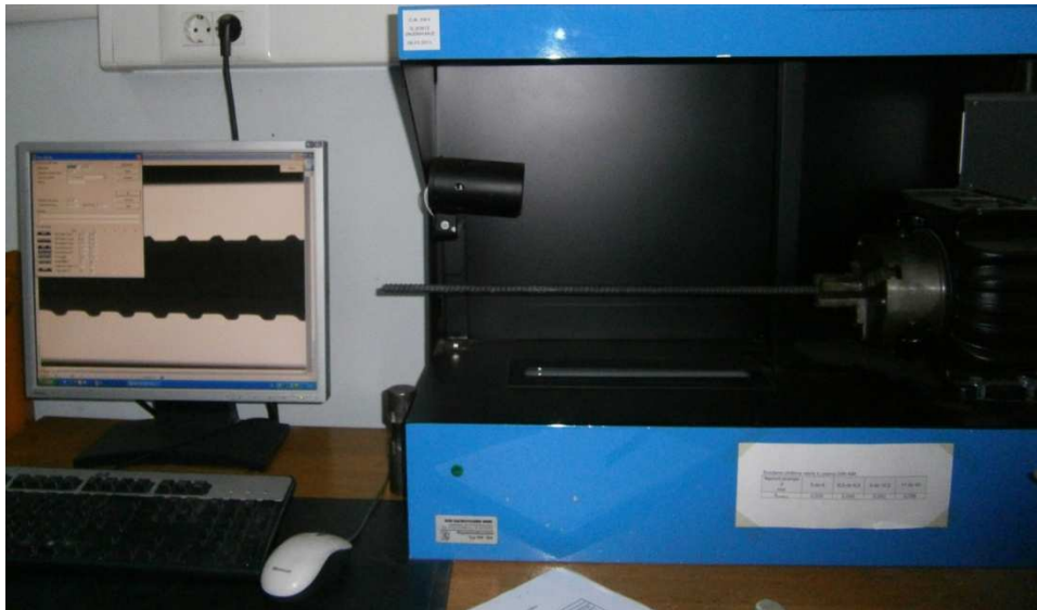
Slika 2.1. Optički uređaj RM 302/202 - ECM Datensysteme GMBH pri mjerenju uzorka 10, laboratorij tvrtke IGH.
