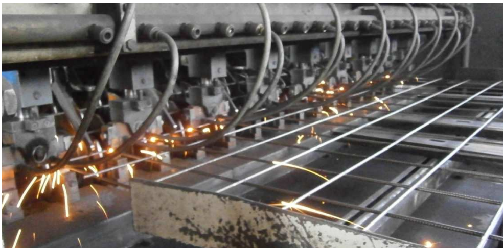
Slika 1.7. Proizvodnja armaturene mreže u pogonu tvrtke ARMKO.
