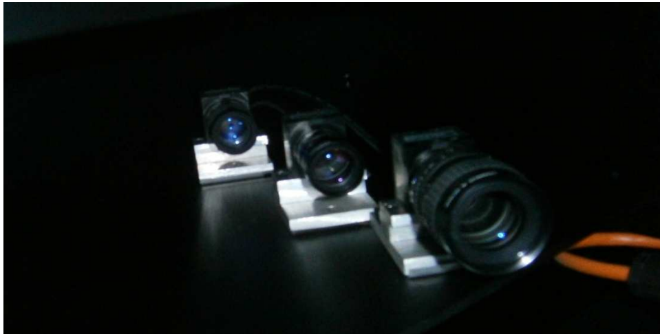
Slika 2.2. Kamere visoke razlučivosti, detalj iz unutrašnjosti uređaja RM 302/202, laboratorij tvrtke IGH.
