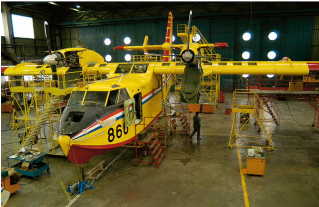
Slika 2. Remont kanadera i pripadajuća oprema
