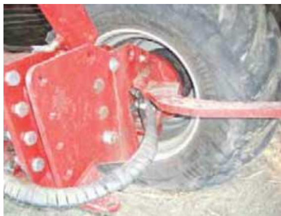
Slika 17 Hidraulički sustav za zakretanje kotača
