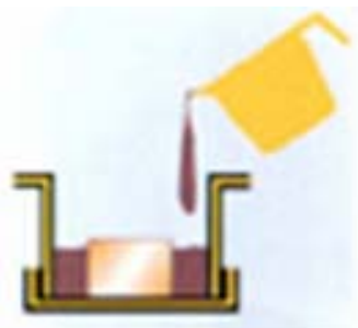
Slika 12. Prikaz zalijevanja uzorka [9]
