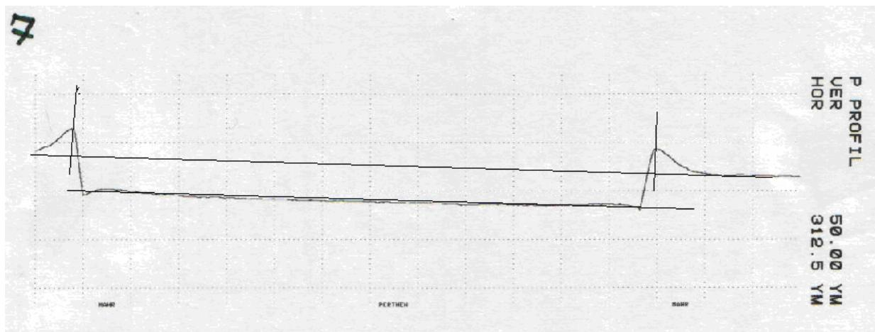
Slika 41. Topograf kratera prevlake Ni – P nakon 300 [s] trajanja ionskog odnošenja
