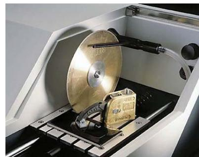
Slika 10. Rezna ploča za izrezivanje uzorka [9]
