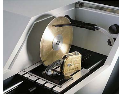
Slika 10. Rezna ploča za izrezivanje uzorka [9]
