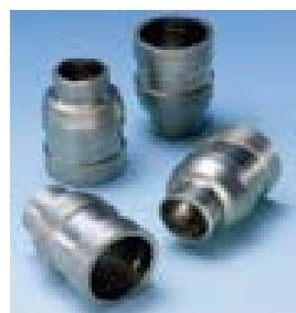
Slika 6. Sonde za ultrazvuk (NDT) [8]
