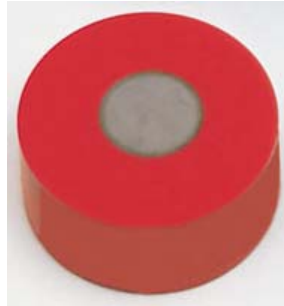
Slika 13. Uzorak spreman za mehaničku obradu [9]
