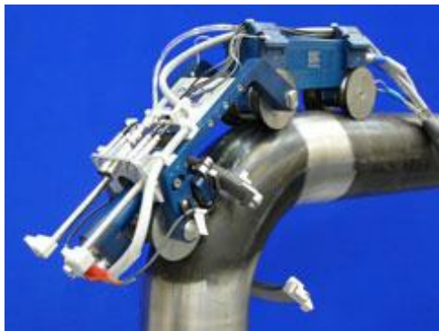
Slika 13. Automatizirani uređaj za snimanje feritnih koljena cijevi
