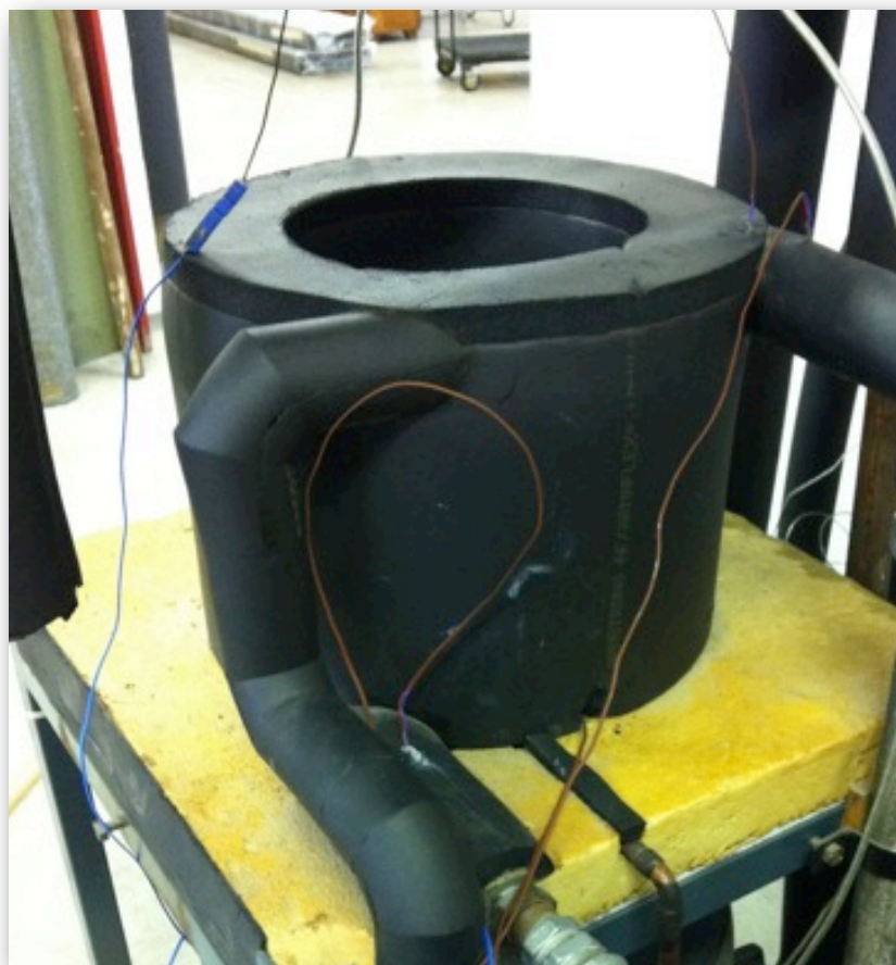
Slika 5. Vodom hlađen kondenzator
