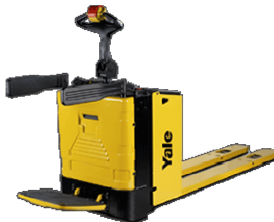
Slika 8. Paletni niskopodizni viličari za utovar/istovar
