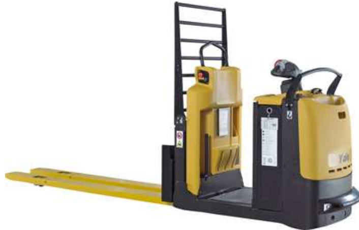
Slika 7. Horizontalni viličar za komisioniranje
