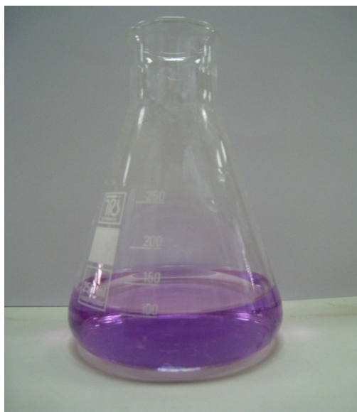
Slika 15. Promjena boje kod određivanja „p“- alkaliteta
