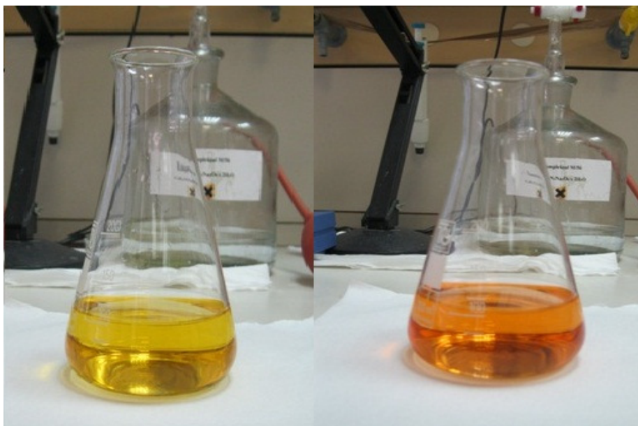
Slika 16. Promjena boje mjerenjem „m“-alkaliteta
