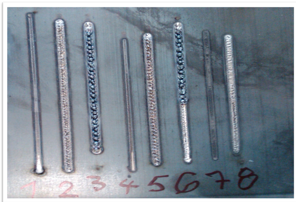
Slika 20. Uvećani prikaz navara na ploči "A"
