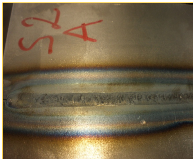
Slika 32. Prikaz lica zavarenog spoja, „S2A“
