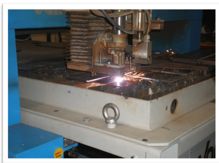
Slika 18. Rezanje ispitnih uzoraka na Vanad-u 2000
