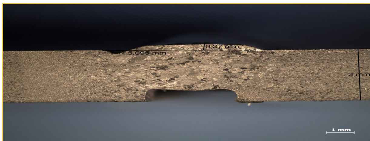
Slika 26. Uvećani prikaz presjeka, prolaz 1, lim "C"
