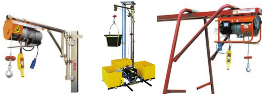
Slika 1:(a) konzolna, (b) podna, (c) kavaletna
