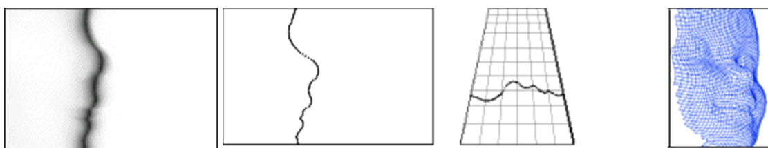
Slika 24. a) Neobrađena video slika, b) Digitalizirana slika, c) Odnos slike i realnog prostora, d) Oblak točaka
