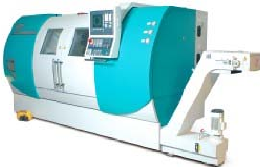
Slika 5.3.1.1. Tokarski obradni centar SBL-500 [25]
