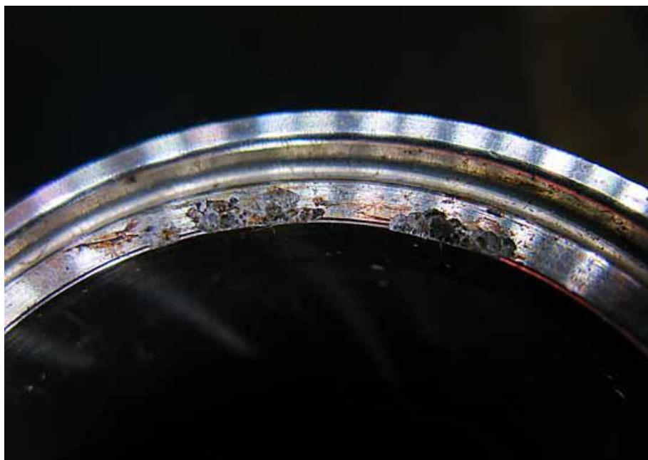
Slika 21. Korozija u procjepu na prirubnici [28].
