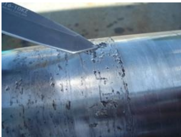
Slika 24. Napetosna korozija osovine [31].
