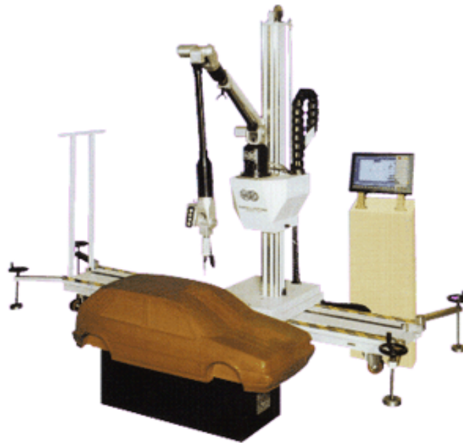
Slika 4.4 Kontaktni optički mjerni uređaj [7]
