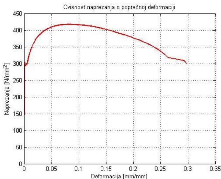
Slika 6.11 Ovisnost napreznja o poprečnoj deformaciji za l_0 = 5 \text{ mm}
