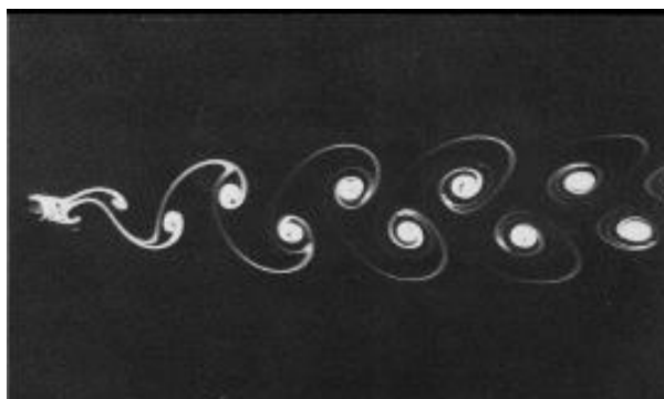
Slika 6: Turbulentno strujanje oko beskonačno dugog valjka
