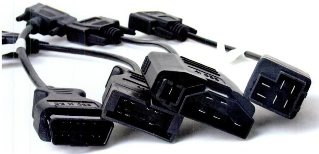
Slika 2.5. Usporedba OBD-II priključka (lijevo) sa OBD-I priključcima različitih proizvođača, General Motors, Ford, Chrysler (s desna na lijevo) [1].
