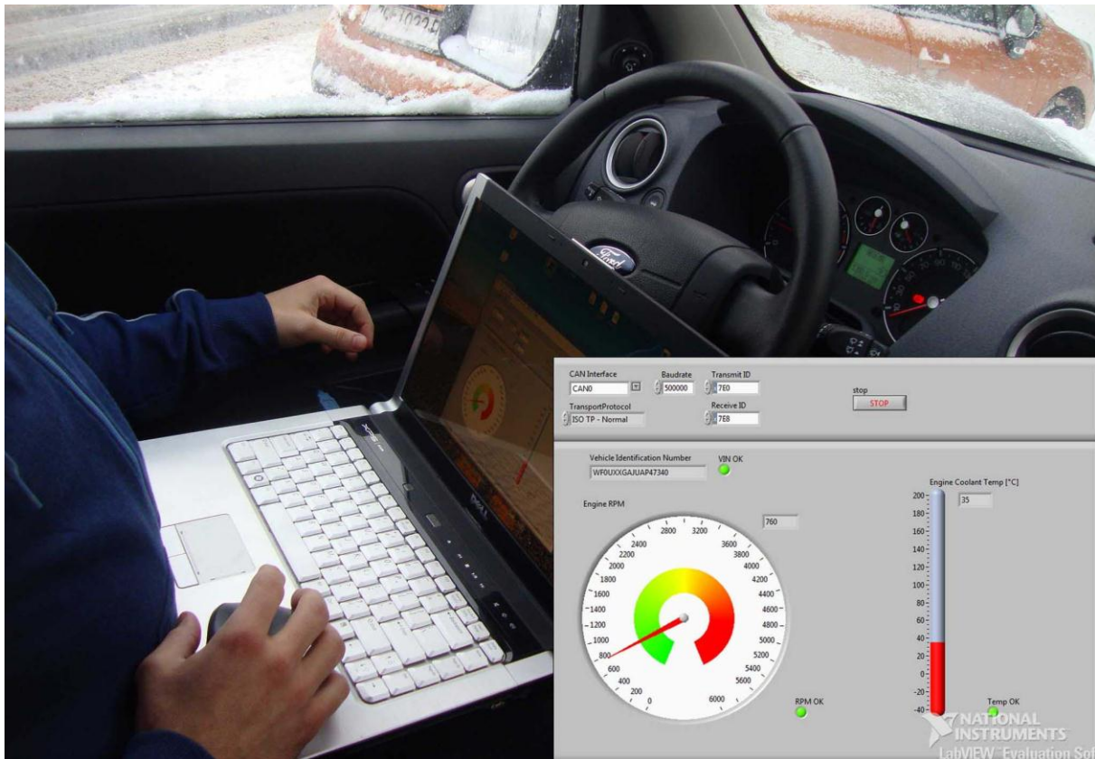
Slika 5.23. Programsko sučelje za očitavanje radnih vrijednosti motora na vozilu Ford Fusion.
