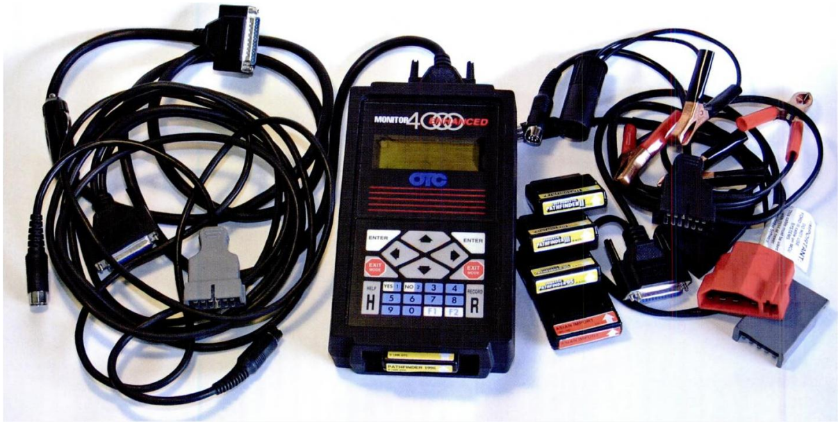
Slika 2.2. OBD-I dijagnostički uređaj Monitor 4000 proizvođača OTC s dodatnim priključcima pomoću koji se spaja na vozila marke GM, Ford, Chrysler i Toyota [1].
