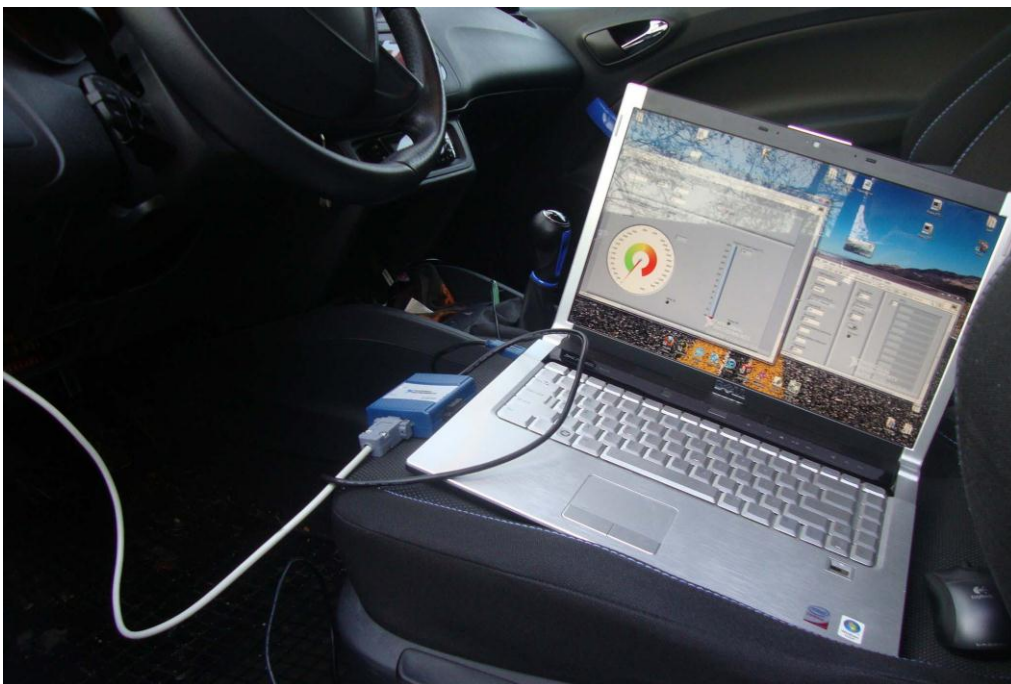
Slika 5.5. LabVIEW povezan sa CAN sabirnicom vozila preko NI USB-8473s uređaja.
