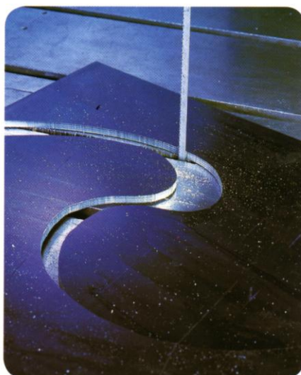
Slika 34. Izrada složene konture na vertikalnoj tračnoj pili [18]
