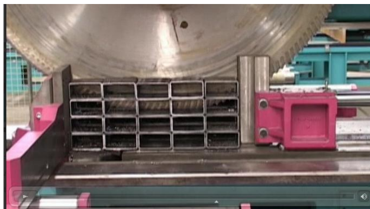
Slika 30. Piljenje više obradaka odjednom kružnim piljenjem [15]
