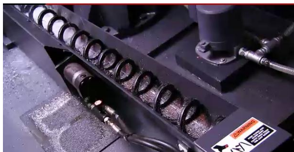
Slika 39. Sustav za odvođenje odvojene čestice [23]
