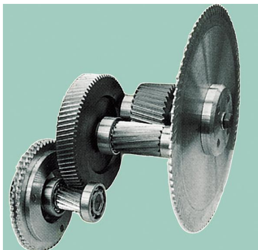
Slika 19. Prijenos kod kružne pile [12]
