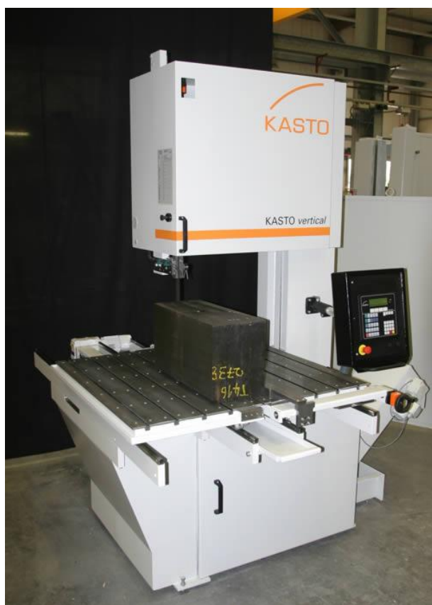
Slika 33. Vertikalna tračna pila [17]
