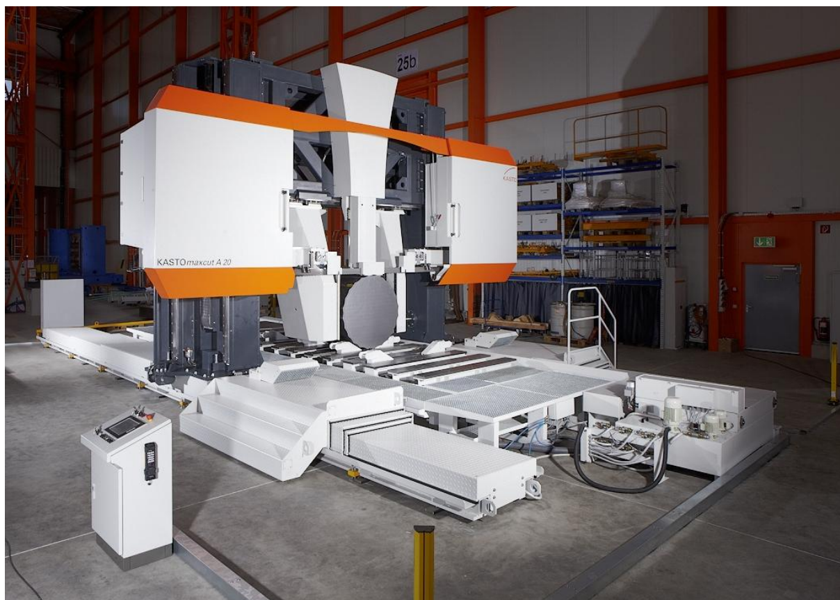
Slika 47. Portalna izvedba tračne pile [28]
