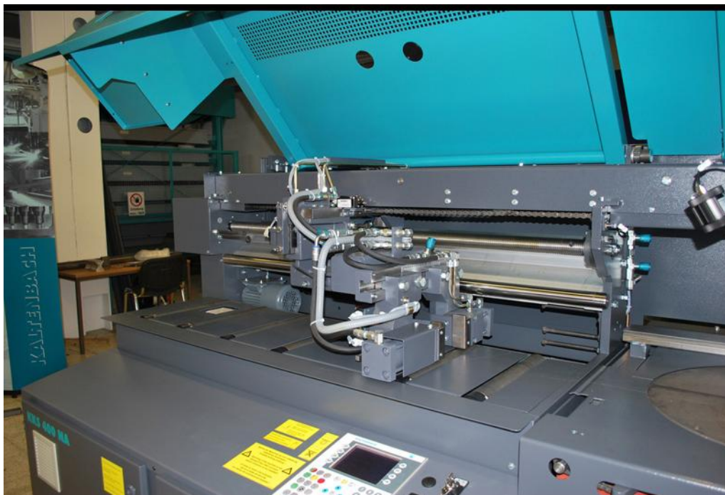
Slika 21. Sustav za upravljanje dostavnim gibanjem [12]
