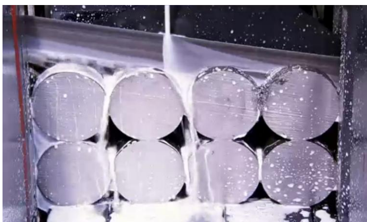
Slika 45. Pijenje više pripremača [26]
