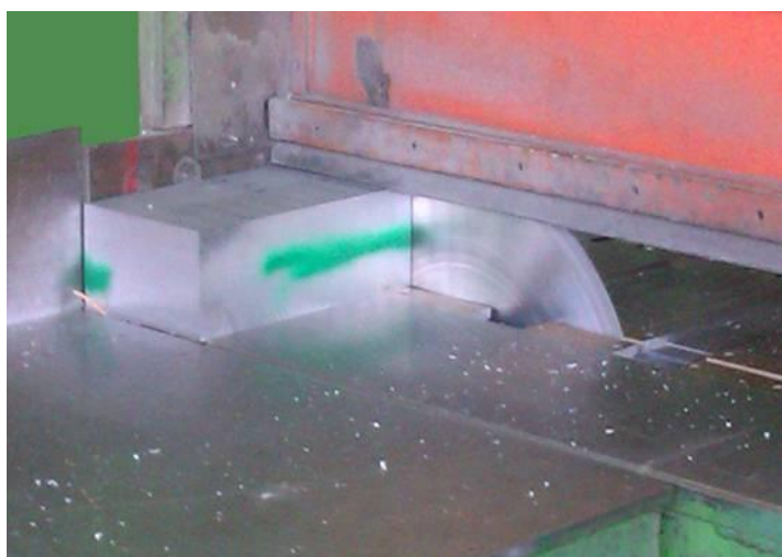
Slika 28. Horizontalno kružno piljenje [3]
