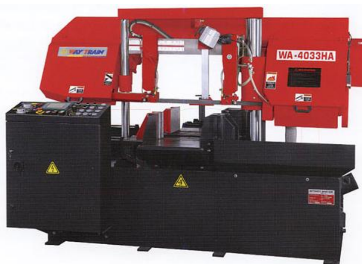
Slika 31. Dvostupna tračna pila [16]
