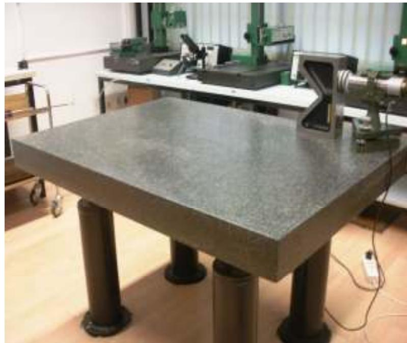
Slika 157: Mjerna ploča
