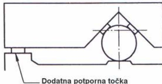
Slika 33: Tijelo na četiri bloka leži na cilindru
