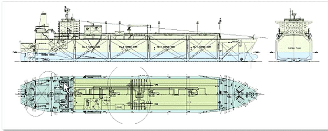
Slika 42: Tipičan raspored tankova kod LNG tankera s membranskim tankovima
