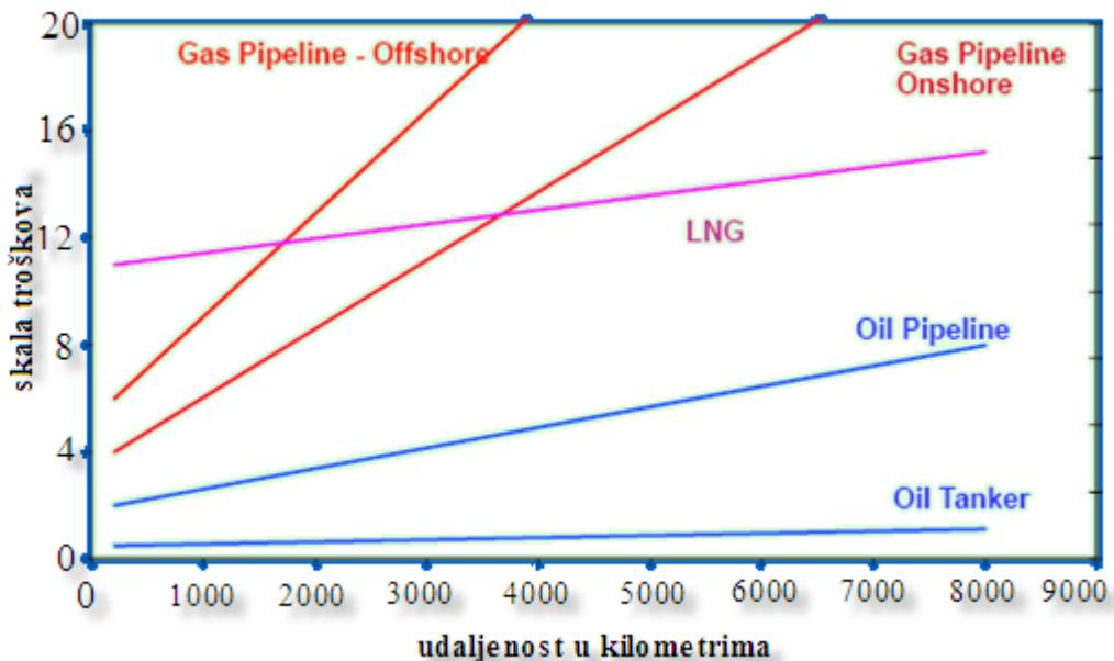
Slika 2: Dijagram usporedbe isplativosti LNG broda naspram cjevovoda
