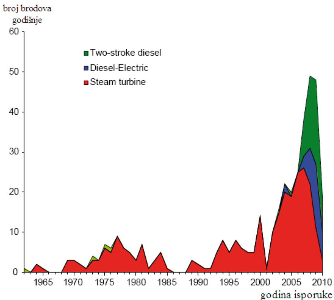
Slika 41: Trend porasta instaliranja sporohodnih Diesel motora na LNG tankerima
