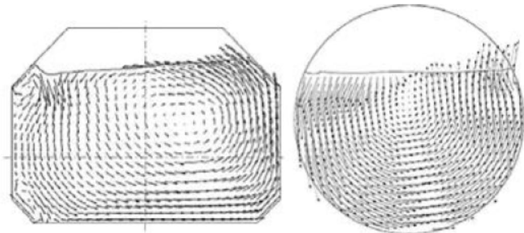
Slika 32: Polje brzina u membranskom i sfernem tanku
