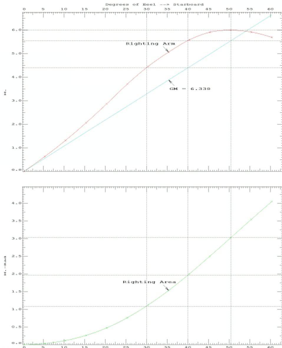
Dijagram 15: Krivulje stabiliteta za treće stanje krcanja LNG broda s membranskim tankom s oblim donjim dijelom i gornjim dijelom u obliku polucilindra (program GHS)
