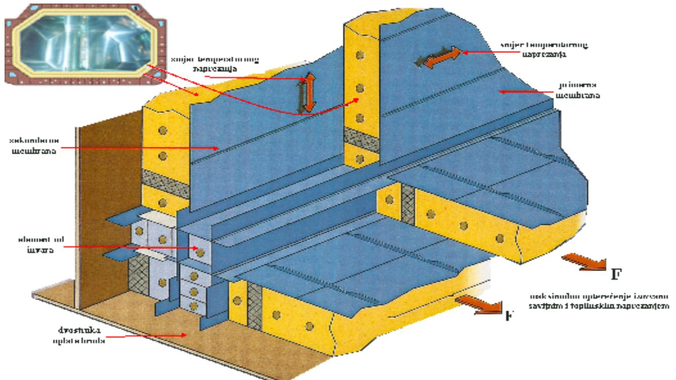
Slika 28: Prikaz po slojevima kutnog dijela Gaztransport No 96 membranskog tanka
