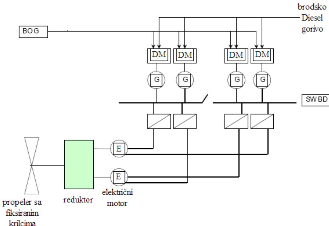
Slika 39: Shema postrojenja LNG broda s Diesel motorima na dvojno gorivo s električnim motorima koji okreću propeler
