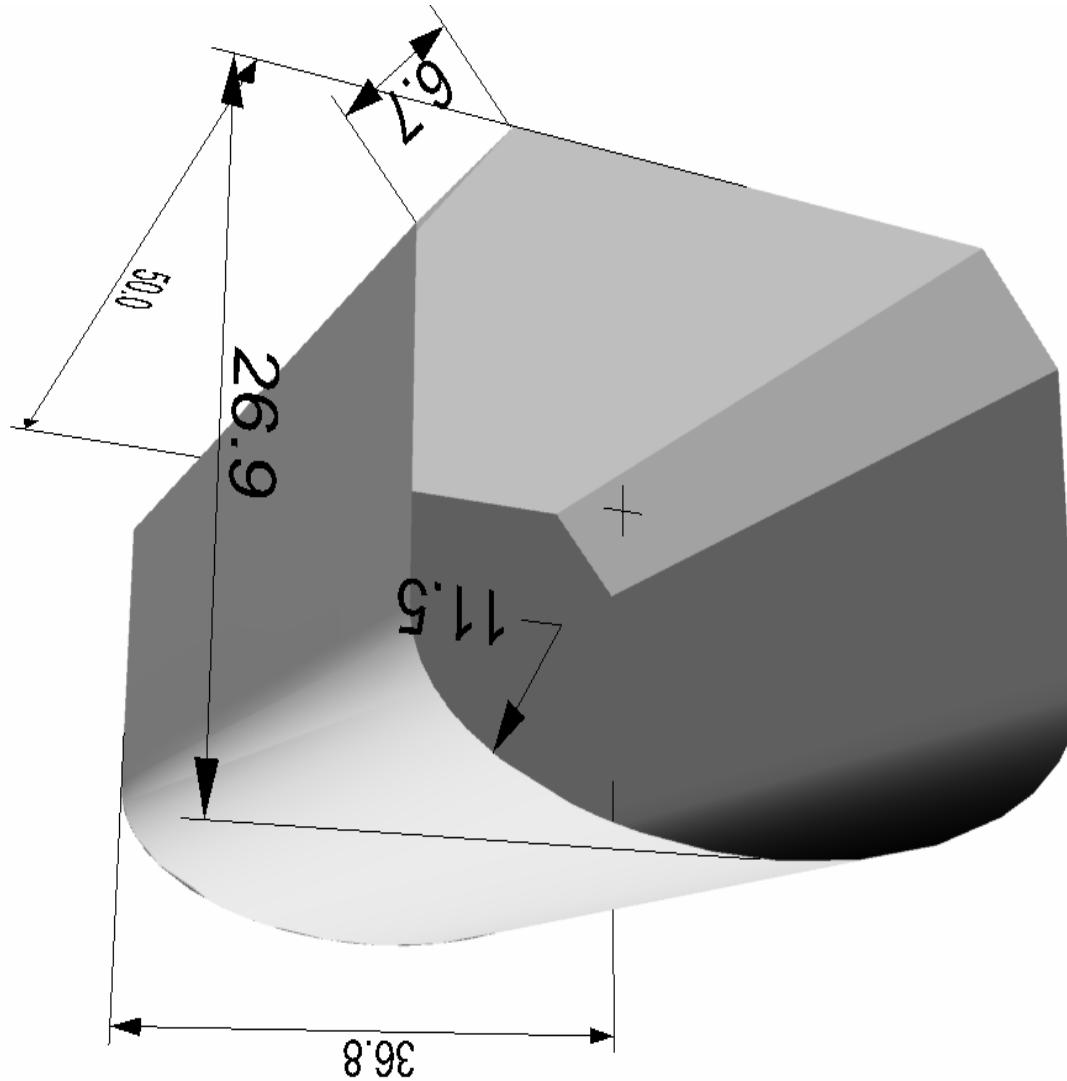
Slika 63: LNG tank,kod poprečnog presjeka donji dio je konvencionalni uglati,gornji dio poluelipsa
