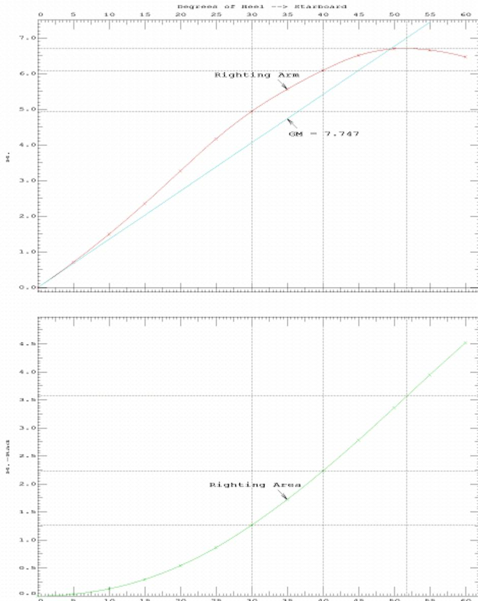
Dijagram 12: Krivulje stabiliteta za četvrti stanje krcanja LNG broda s membranskim tankom u obliku kvadra s oblim rubovima ( program GHS )
