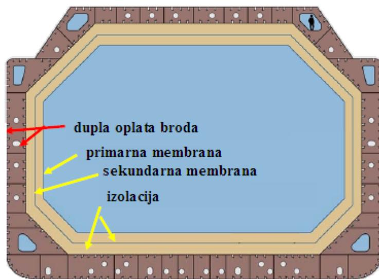
Slika 19: Poprečni presjek membranskog tanka
