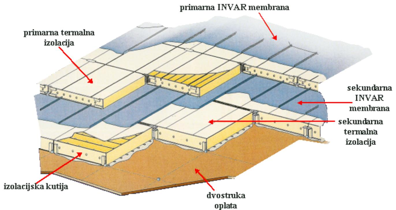
Slika 27: Prikaz po slojevima Gaztransport No 96 membranskog tanka
