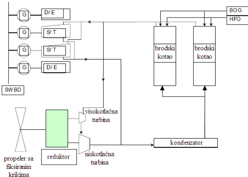
Slika 38: Shema postrojenja LNG broda s parnom turbinom
