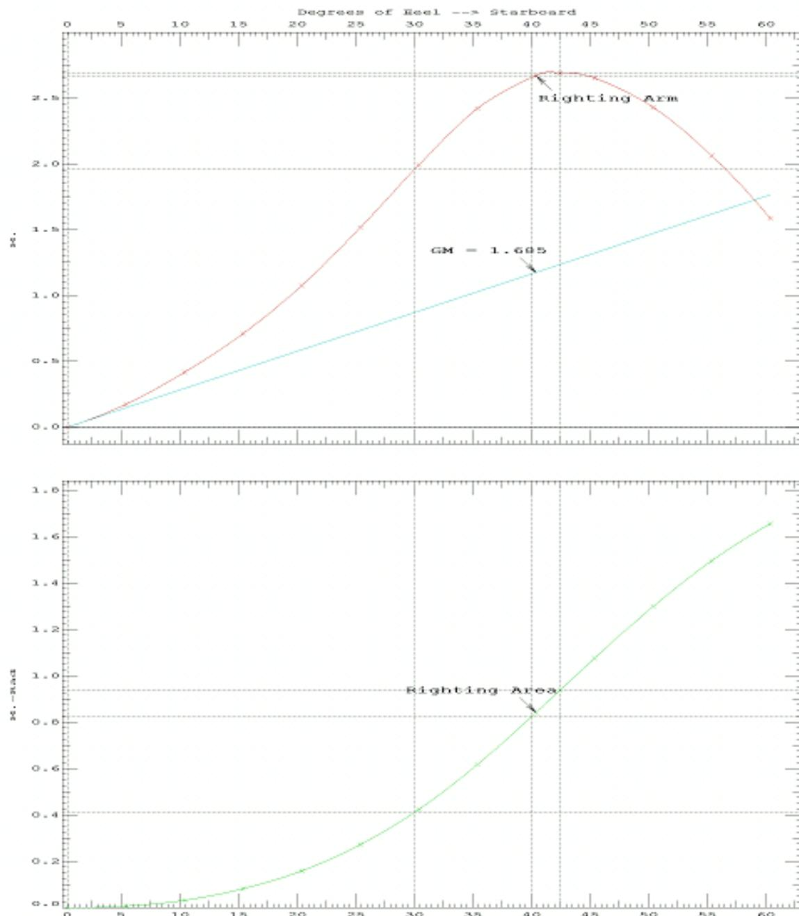
Dijagram 1: Krivulje stabiliteta za prvo stanje krcanja LNG broda s konvencionalnim oblikom membranskog tanka
