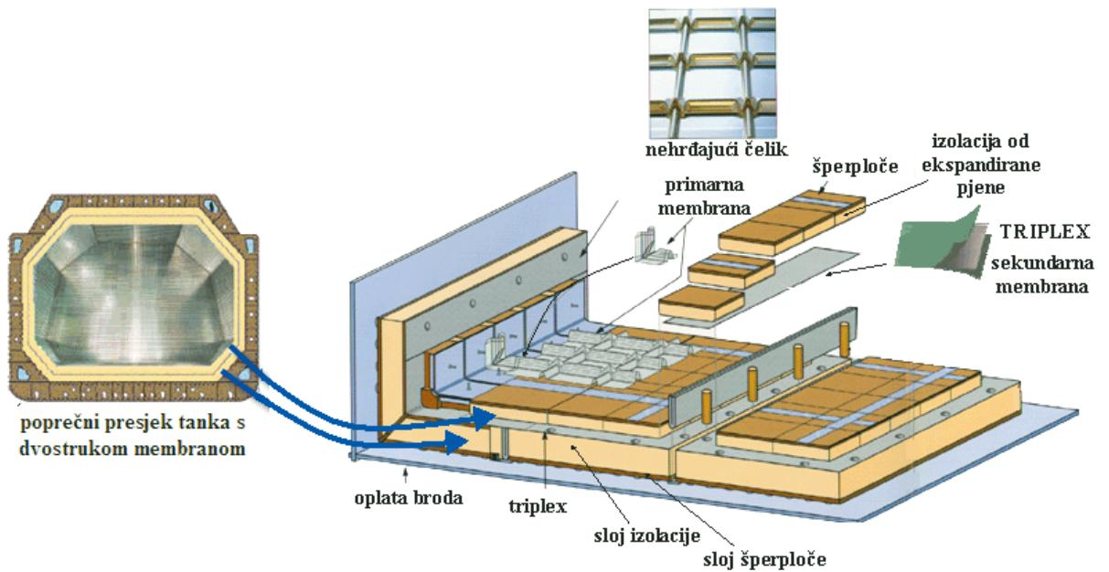
Slika 23: Mark III Technygas membranski tank
