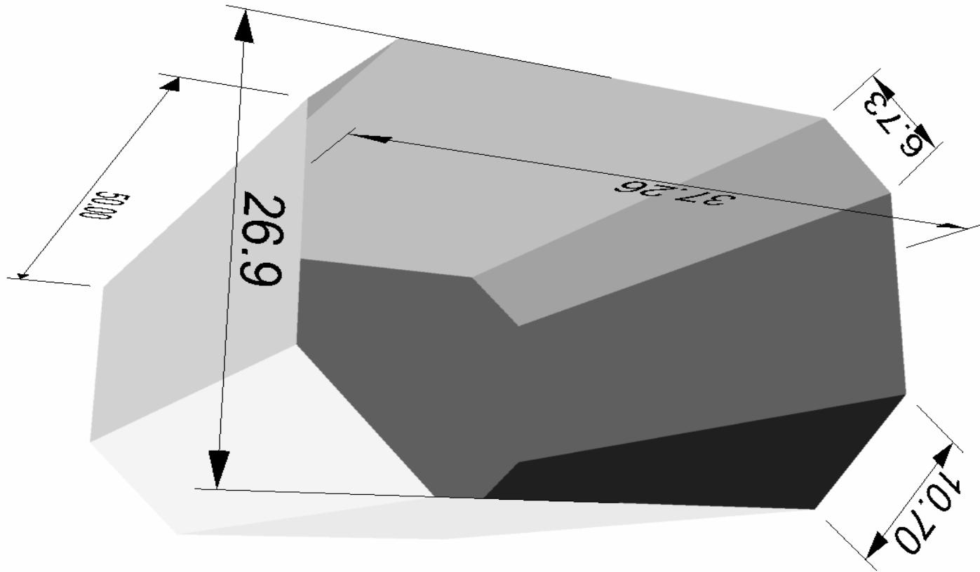
Slika 46: Konvencionalni oblik membranskog tanka na LNG tankeru
