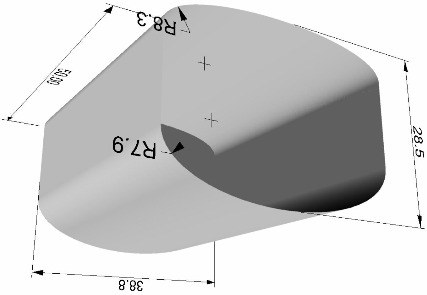
Slika 51: LNG tank poprečni presjek sa poluelipsom na donjem i gornjem dijelu
