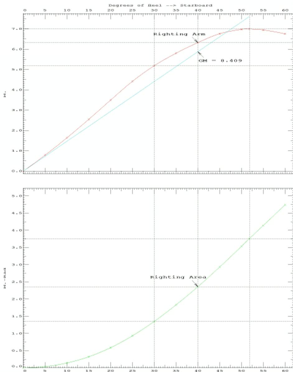
Dijagram 16: Krivulje stabiliteta za četvrti stanje krcanja LNG broda s membranskim tankom s oblim donjim dijelom i gornjim dijelom u obliku polucilindra (program GHS)
