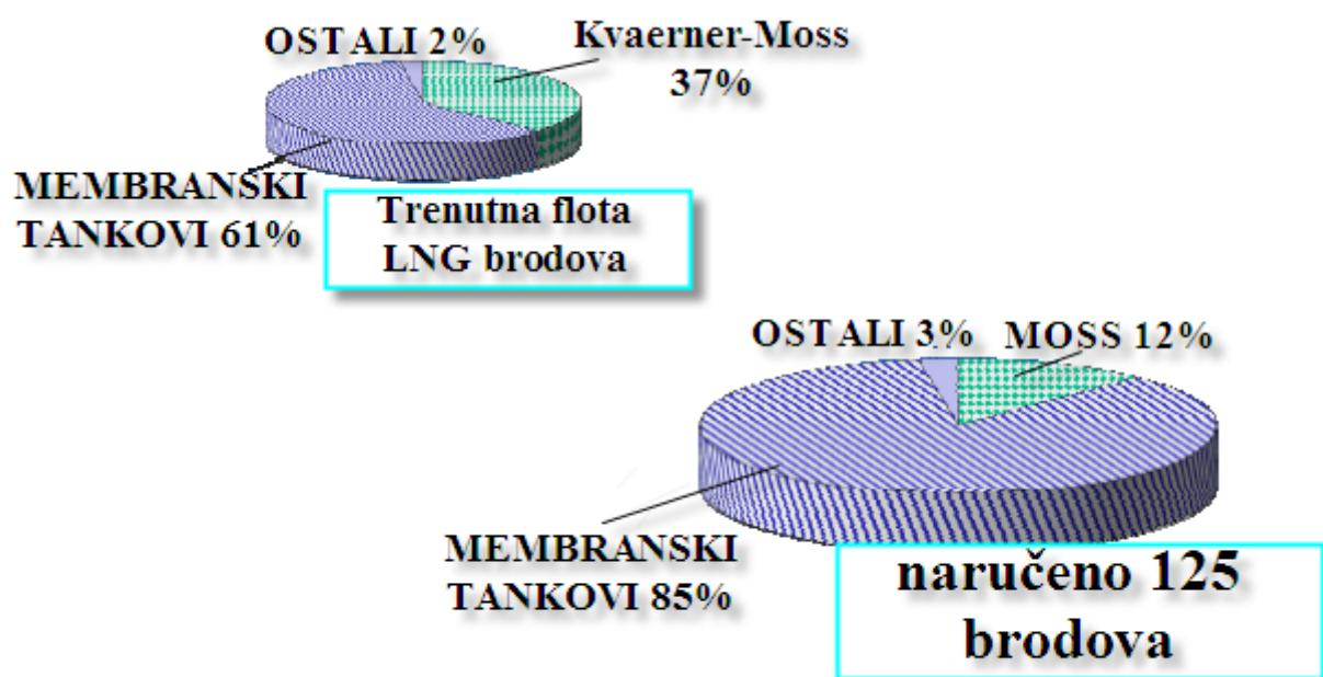
Slika 9: Udio pojedinog tipa tanka u ukupnoj floti LNG tankera
