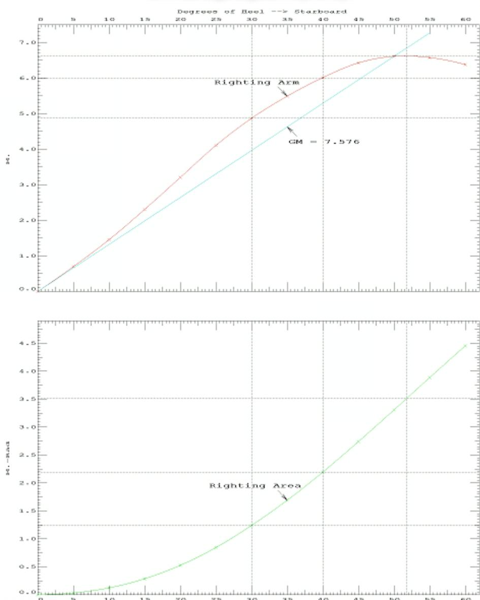
Dijagram 4: Krivulje stabiliteta za četvrti stanje krcanja LNG broda s konvencionalnim oblikom membranskog tanka ( program GHS )
