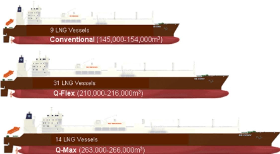
Slika 34: Usporedba-konvencionalni LNG tanker, Q-flex i Q-max
