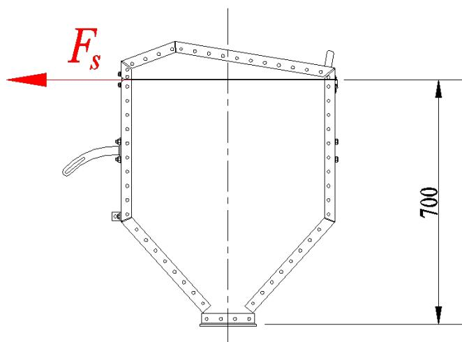
Slika 38. Opterećenje zavara prirubnice
