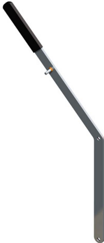
Slika 49. Ručka zatvarača
