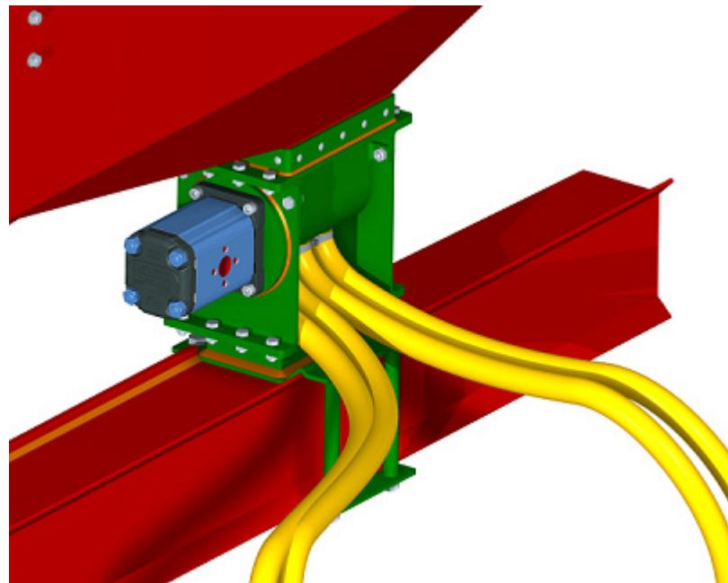
Slika 41. Spoj razdjelnika sa spremnikom i nosačem
