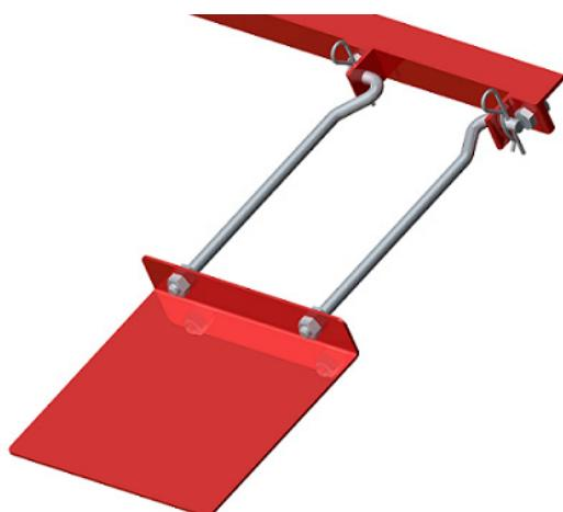
Slika 48. Spoj zatvarača s L-profilom
