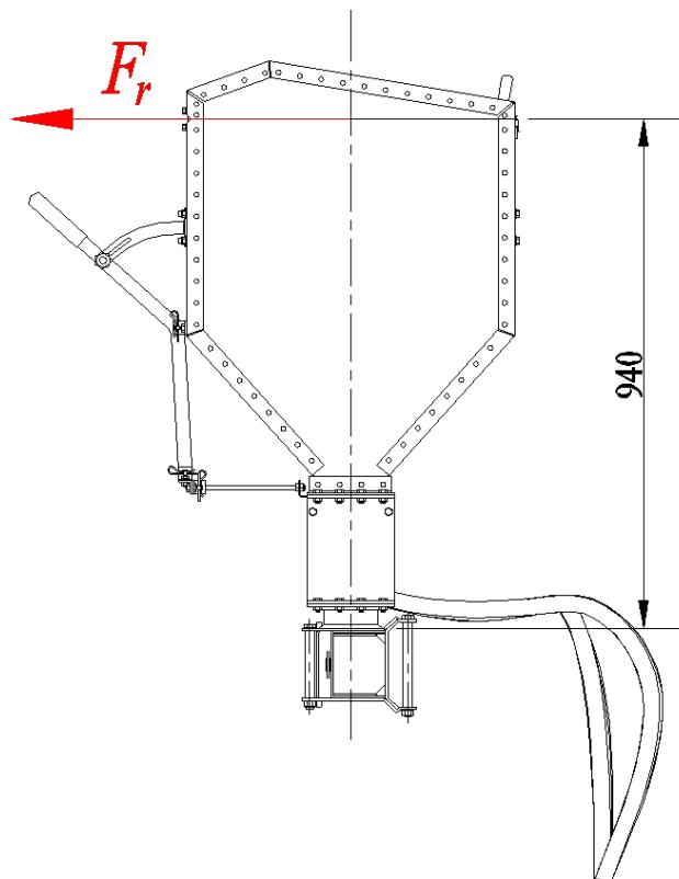
Slika 45. Opterećenje zavara nosača
