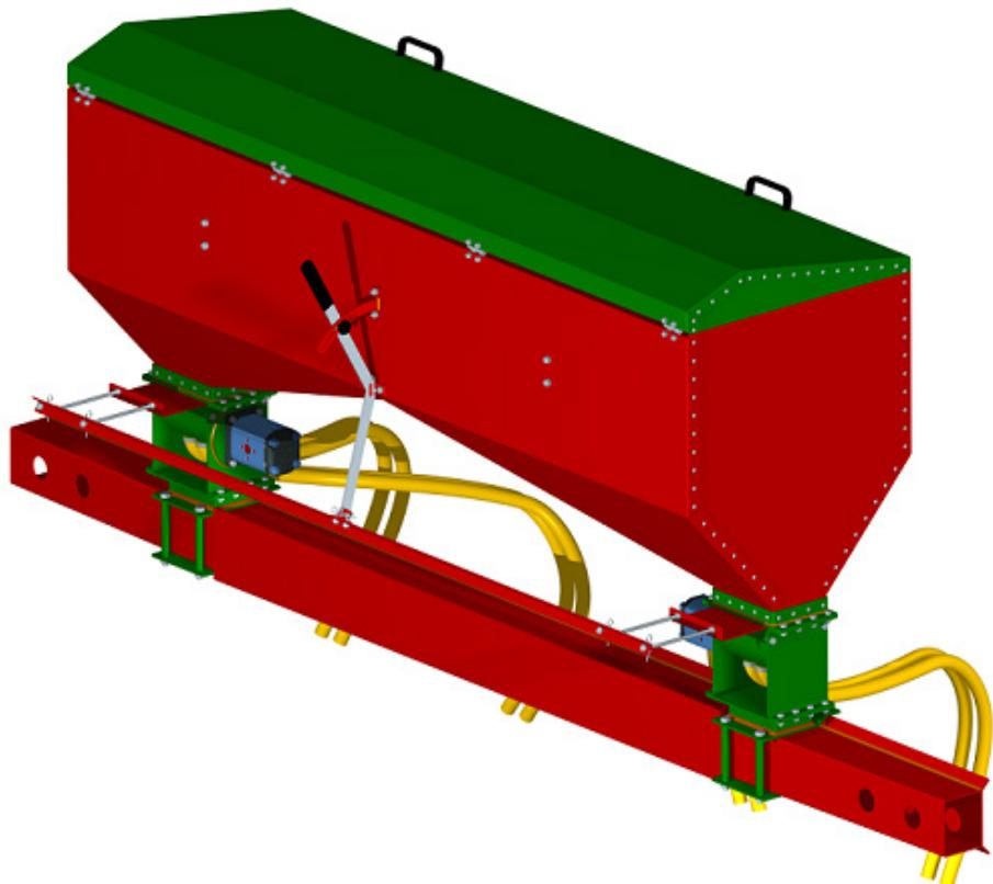
Slika 57. Rasipač umjetnog gnojiva (pogled na polužni zatvarač)
