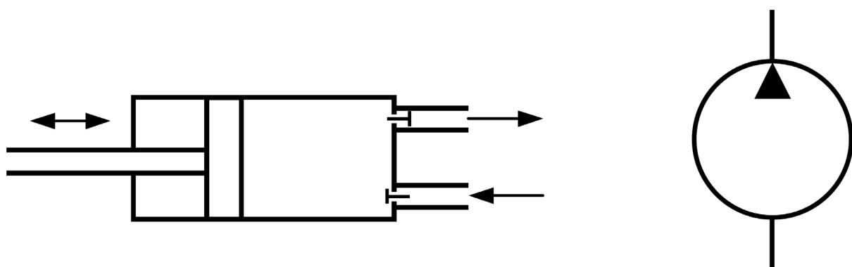
**Slika 4. Princip rada i simbol volumenske pumpe**
