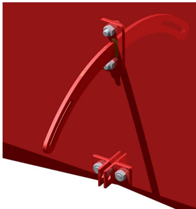
Slika 34. Spoj vodilice zatvarača i L-profila sa spremnikom
