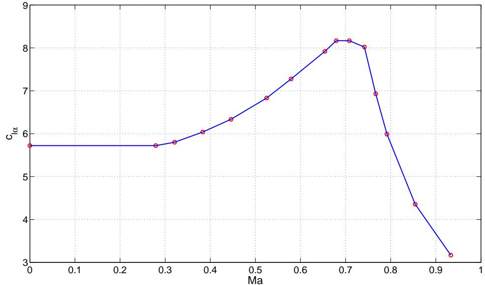
Slika B.1: Promjena kuta nagiba linearne ovisnosti uzgona o napadnom kutu profila NACA 0012 s Machovim brojem
