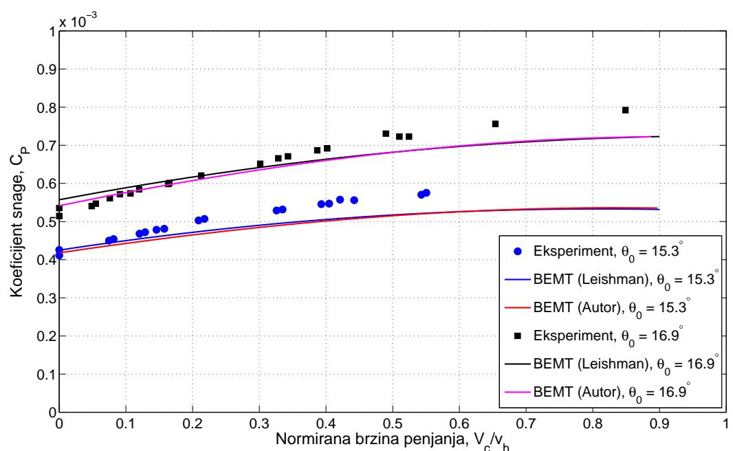
Slika 4.7: Usporedba BEMT rezultata s eksperimentalnim za snagu ovisno o
