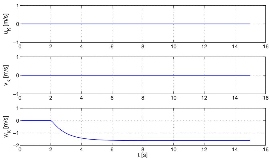
Slika 7.5: Brzine - vertikalno penjanje (step pobuda)
