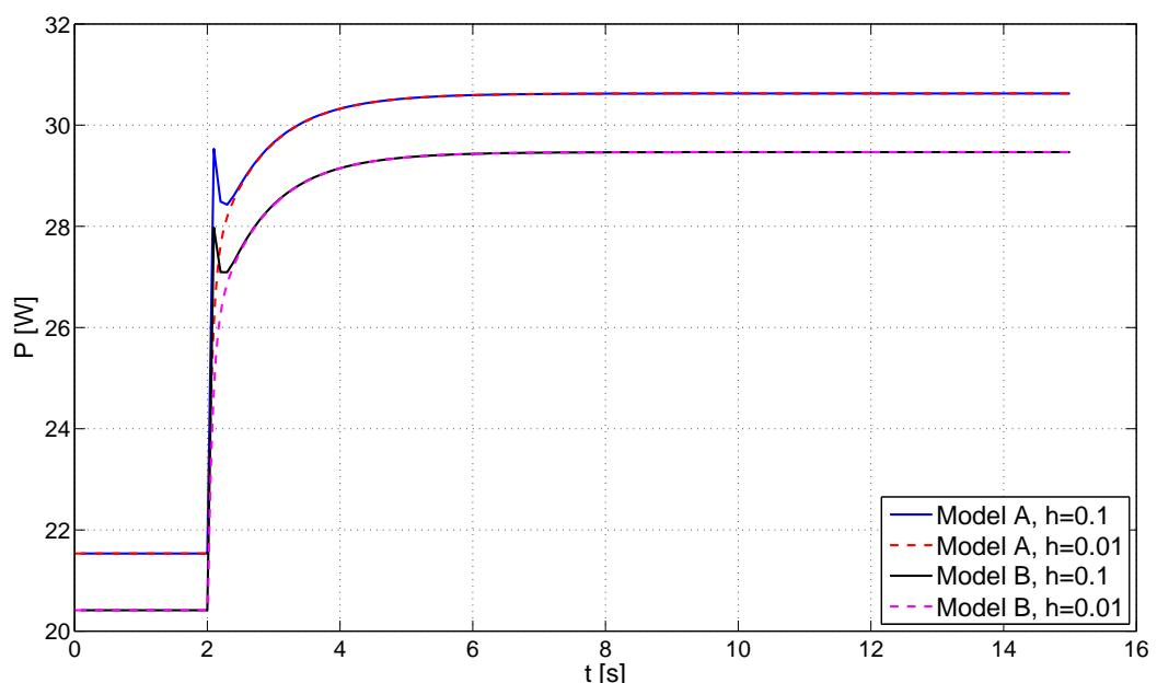
Slika 7.1: Usporedba rezultata snage za različite modele otpora profila i različite korake integracije
