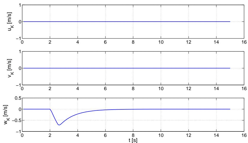
Slika 7.11: Brzine - vertikalno penjanje (impulsna pobuda)
