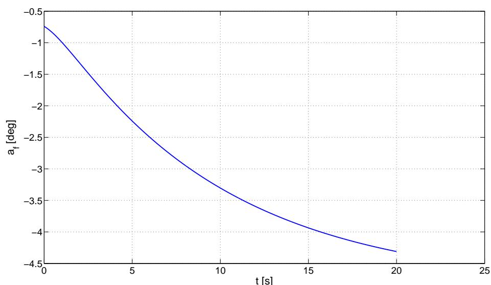
Slika 7.59: Napadni kut trupa letjelice - pojednostavljeni horizontalni let
