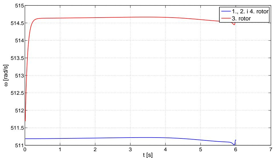
Slika 7.41: Kutna brzina motora - horizontalni let s pobudom
