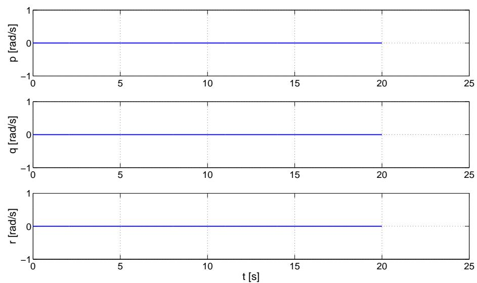
Slika 7.55: Kutne brzine - pojednostavljeni horizontalni let
