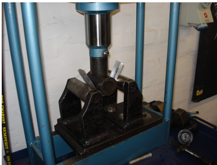
Slika 72. Savijanje epruvete na napravi za savijanje
