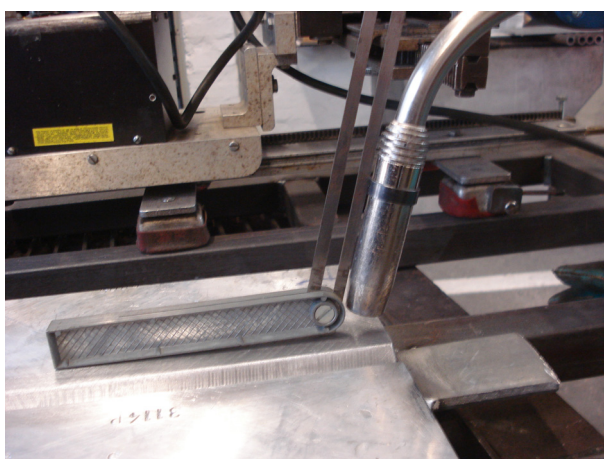
Slika 29. Namještanje pištolja za zavarivanje
