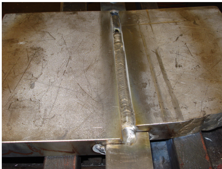
Slika 39. Korijenski zavar izveden TIP-TIG postupkom
