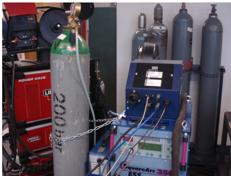
Slika 35. Uređaj za TIP-TIG zavarivanje
