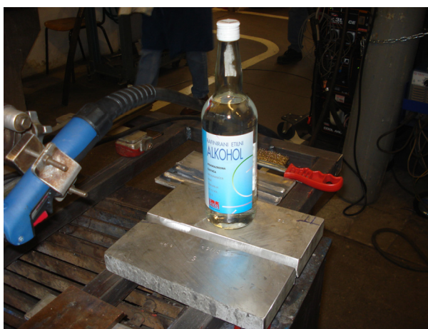
Slika 24. Čišćenje ploča za zavarivanje
