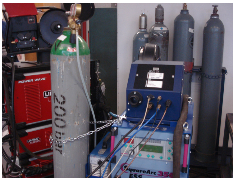
Slika 35. Uređaj za TIP-TIG zavarivanje
