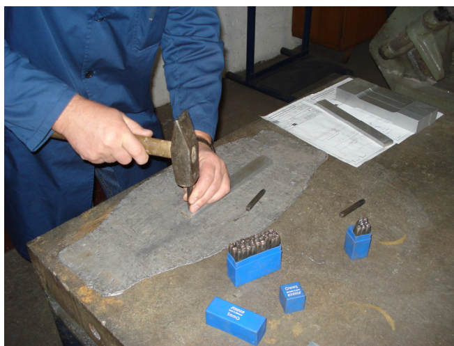
Slika 69. Označavanje epruveta za ispitivanje savijanjem
