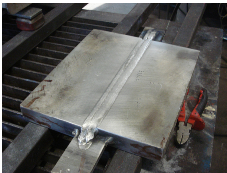
Slika 34. Izgled završnih prolaza izvedenih MIG postupkom
