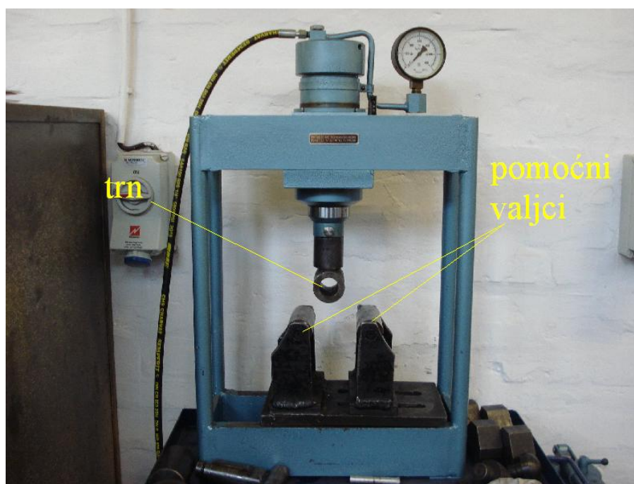
Slika 71. Naprava za ispitivanje zavarenih spojeva na savijanje
