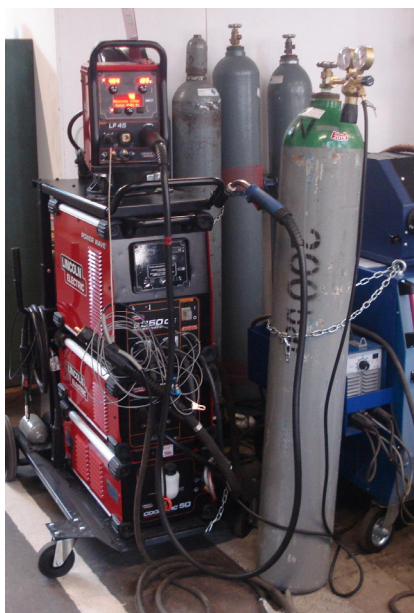
Slika 28. Uređaj za MIG zavarivanje Lincoln Electric S 350 CE
