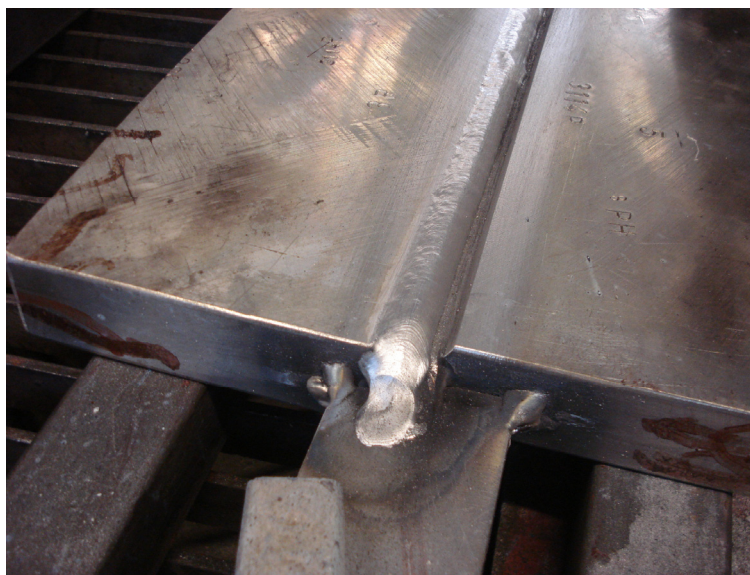
Slika 33. Izgled međuprolaza izveden MIG postupkom
