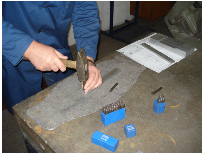
Slika 69. Označavanje epruveta za ispitivanje savijanjem
