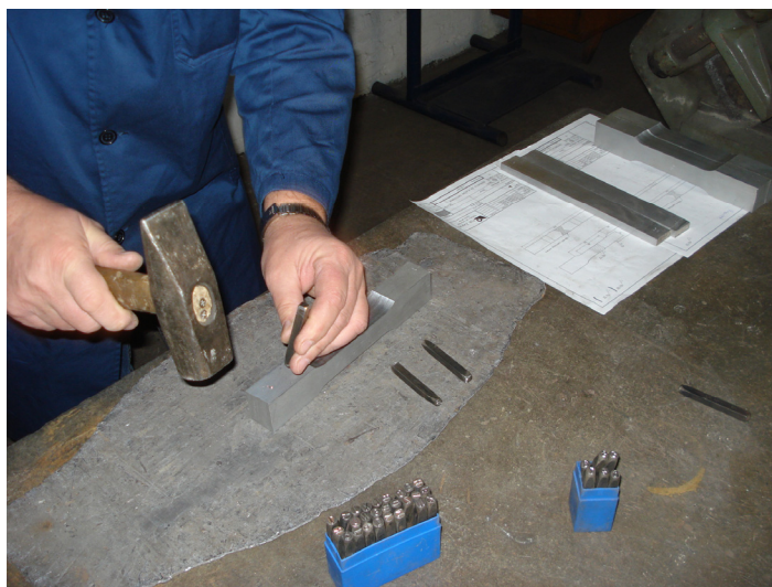
Slika 60. Označavanje epruveta za statički vlačni pokus
