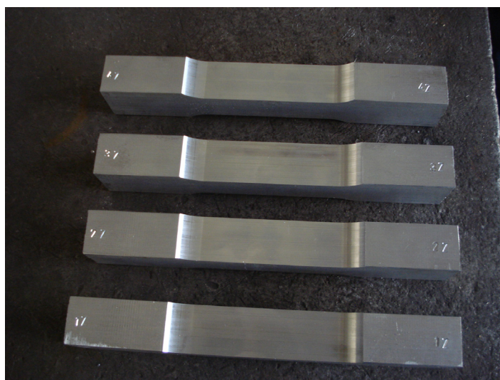
Slika 61. Označene epruvete za statičko vlačni pokus
