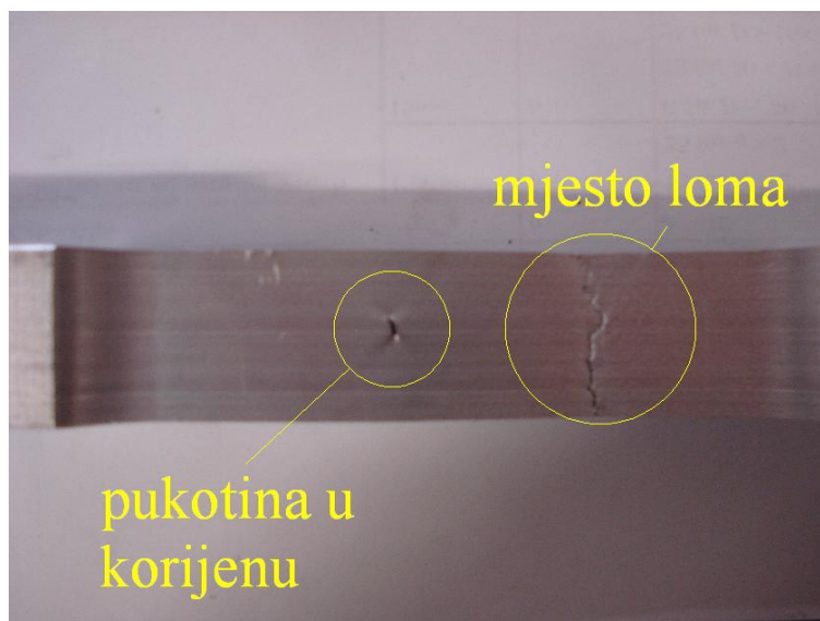
Slika 66. Epruveta 1Z nakon kidanja
