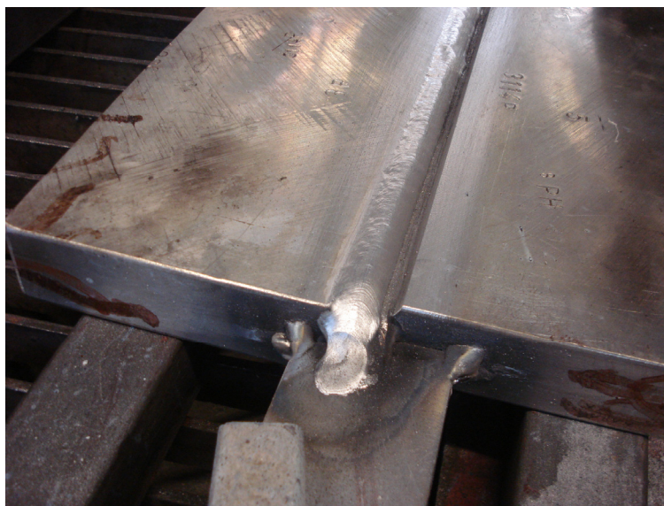
Slika 33. Izgled međuprolaza izveden MIG postupkom
