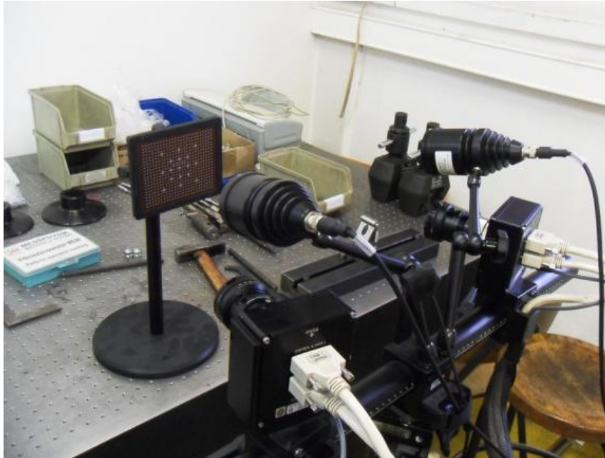
Slika 15. Kalibriranje Aramis sustava
