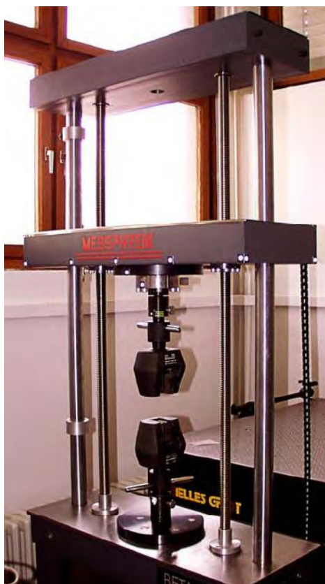
Slika 11. Statička kidalica Messphysik Beta 50-5
