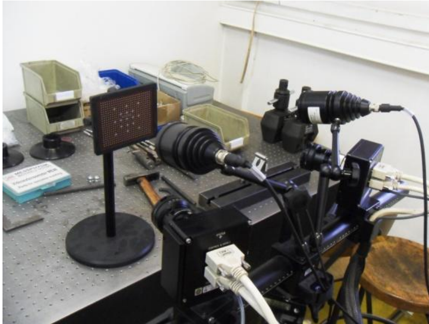
Slika 15. Kalibriranje Aramis sustava
