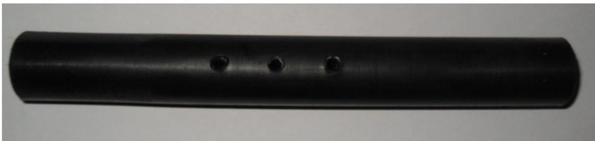
Slika 19. Epruveta od poliacetala
