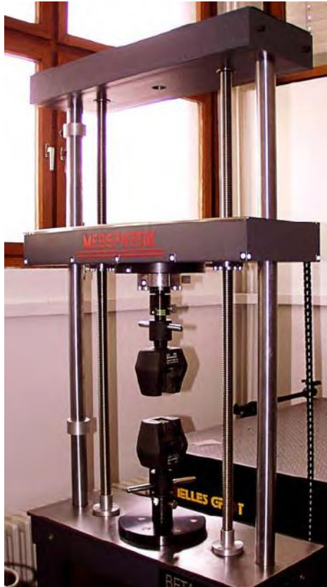
Slika 11. Statička kidalica Messphysik Beta 50-5
