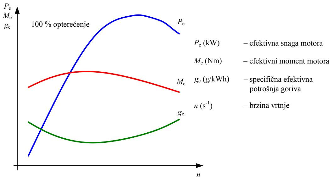
Slika 1.1. Značajke motora pod punim opterećenjem [1]
