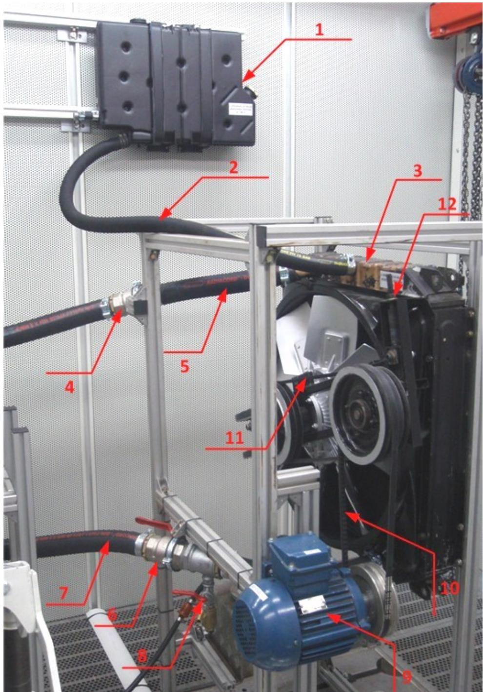
1 – spremnik za vodu; 2 – fleksibilno crijevo dovoda vode u hladnjak iz spremnika za vodu; 3 – hladnjak vode; 4 – kuglasti ventil 2"; 5 – fleksibilno crijevo dovoda vode u hladnjak; 6 – kuglasti ventil 2"; 7 – fleksibilno crijevo odvoda vode iz hladnjaka; 8 – kuglasti ventil 1/2" za ispuštanje vode iz hladnjaka; 9 – trofazni asinkroni elektromotor snage 1,1 kW; 10 – klinasti remen 13x1350 La; 11 – klinasti remen 13x1443 La; 12 – natezač klinastog remena
