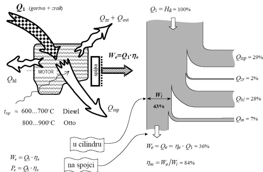
Slika 2.7. Razdioba energije motora prikazana SANKEYevim dijagramom [1]
