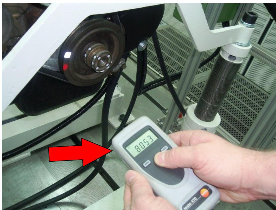
*Slika 5.13. Optičko mjerjenje brzine vrtnje uređajem testo 470*
