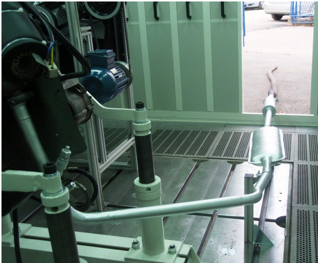
*Slika 5.5. Ispušni sustav ispitnog motora FIAT 128A*
