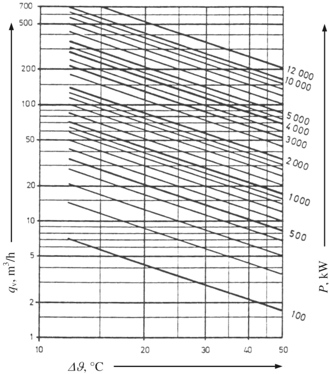
Slika 4.14. Dijagram potrošnje vode hidrauličke kočnice SCHENCK [2]
