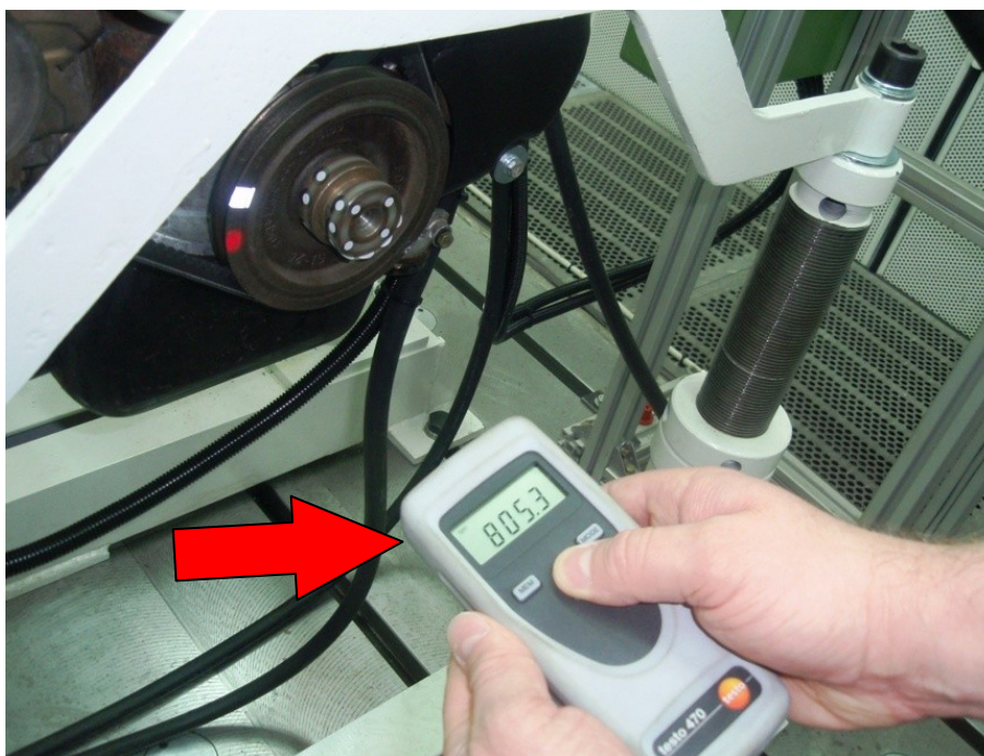
Slika 5.13. Optičko mjerenje brzine vrtnje uređajem testo 470
