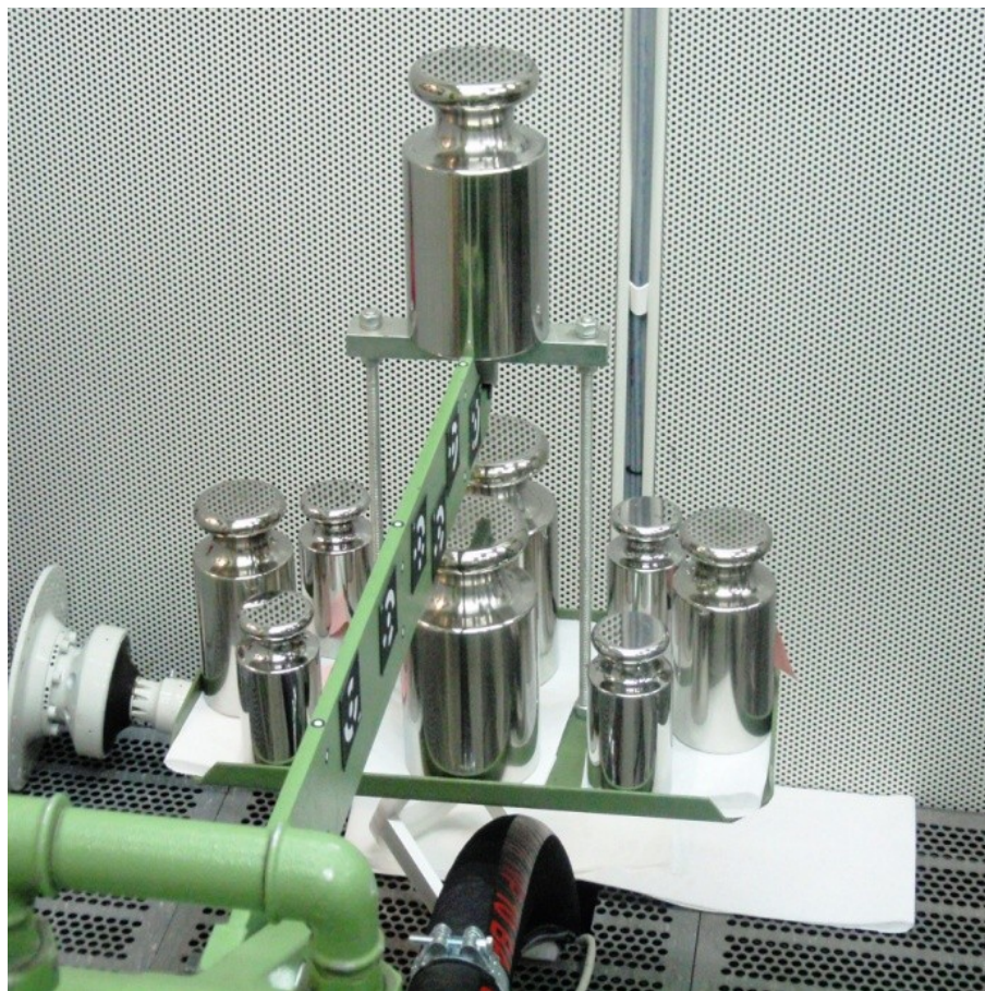
Slika 6.8. Postupak umjeravanja momenta utezima
