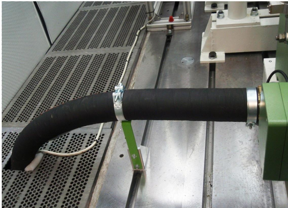
*Slika 4.16. Ovod vode iz hidrauličke kočnice u odvodnu cijev*
