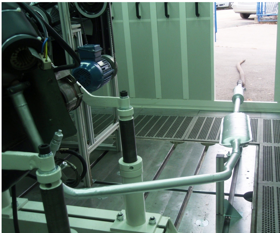
Slika 5.5. Ispušni sustav ispitnog motora FIAT 128A
