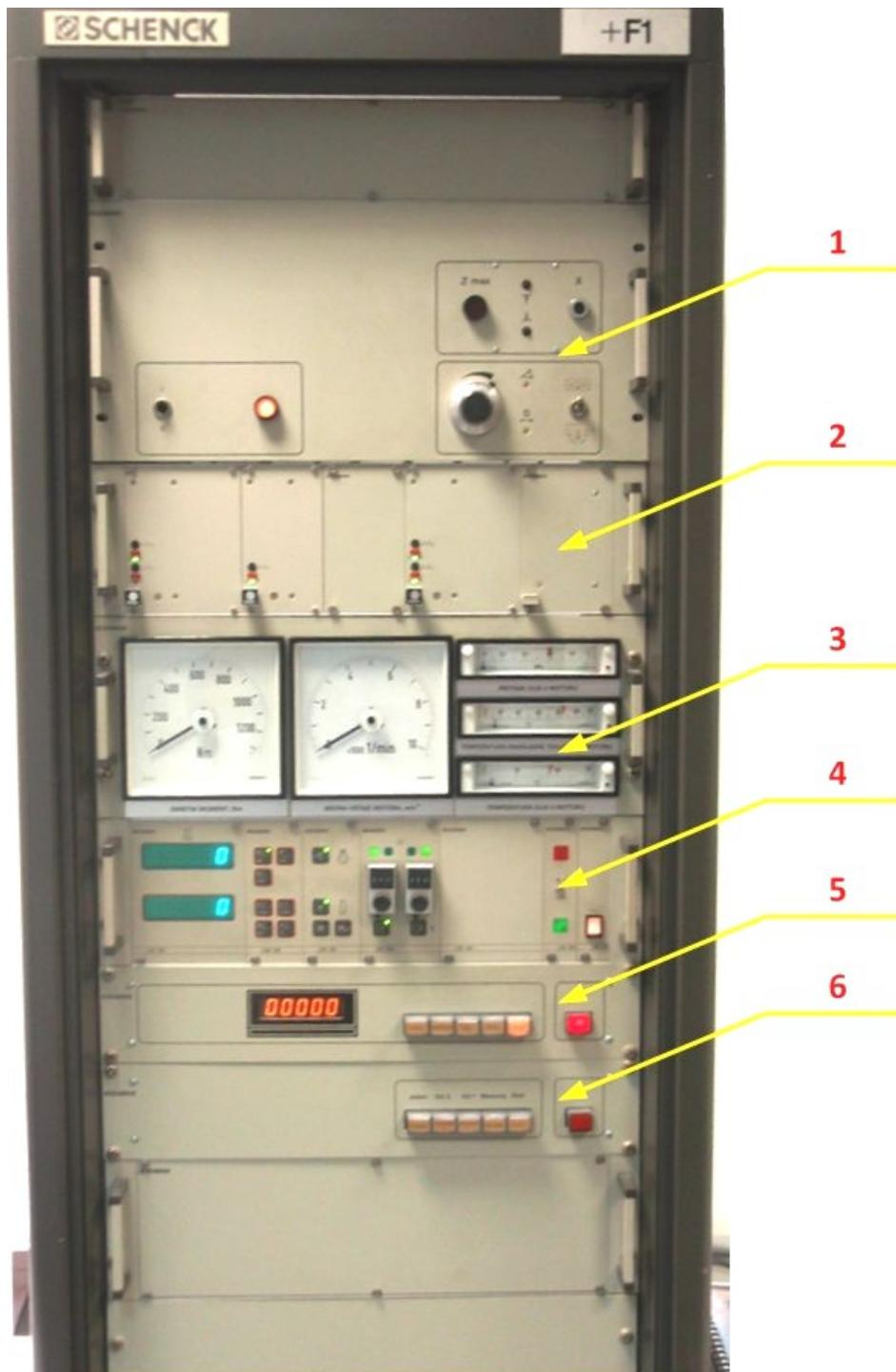
1 – upravljački modul aktuatora zaklopke snage ispitnog motora; 2 – modul za kontrolu i podešavanje PID parametara hidrauličke kočnice; 3 – analogni pokaznici okretnog momenta, brzine vrtnje, pritiska ulja u motoru, temperature rashladne tekućine u motoru, temperature ulja u motoru; 4 – modul upravljanja radom kočnice; 5 – višefunkcionalni brojač; 6 – modul upravljanja uređajem za mjerjenje protoka goriva
