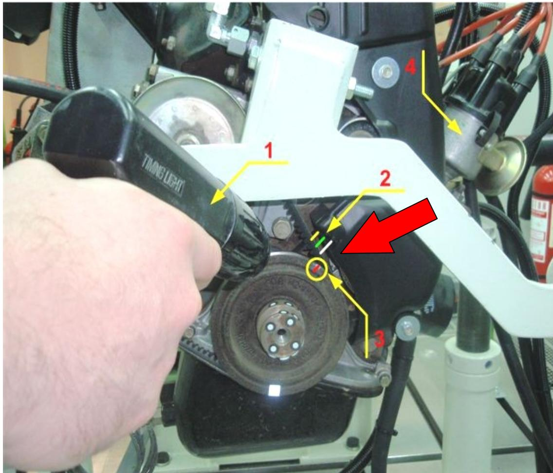
1 – mikroprocesorska digitalna stroboskopska svjetiljka; 2 – oznake kuta zakreta koljenastog vratila na poklopcu razvodnog mehanizma (žuta linija  $10^\circ$  prije GMT, zelena linija  $5^\circ$  prije GMT, bijela linija GMT); 3 – oznaka na remenici motora; 4 – razvodnik paljenja
