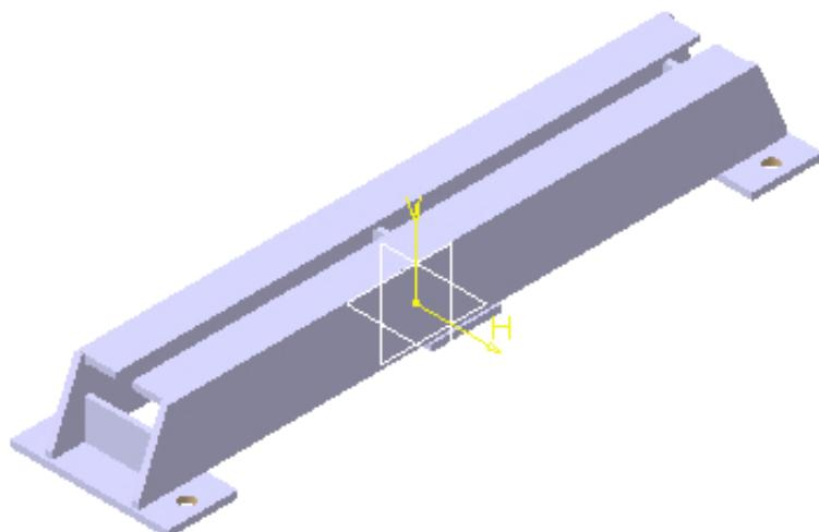
Slika 4.2. 3D model nosača motora
