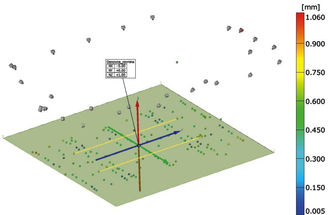
*Slika 3.5. Izračunati položaj kamera i mjernih letvi u trenutku mjerjenja*
