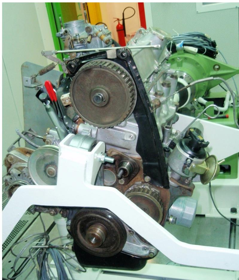
*Slika 5.8. Zamjena zupčastog remena razvodnog mehanizma ispitnog motora*
