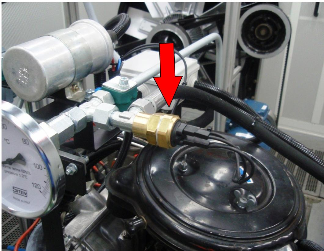
Slika 5.4. Termoprekidač ( $92\text{ }^{\circ}\text{C} / 87\text{ }^{\circ}\text{C}$ )
