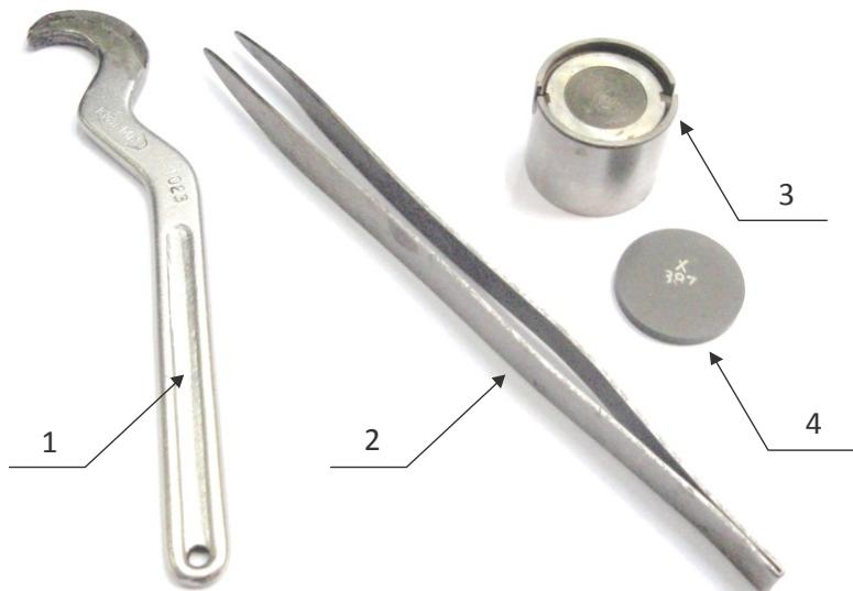
1 – alat za sabijanje ventilskih opruga, 2 – kliješta za vađenje pločica iz čašastog podizača, 3 – čašica podizača, 4 – pločica za podešavanje zračnosti)
