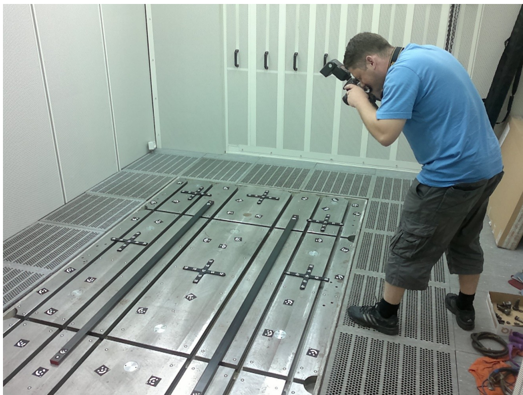
Slika 3.4. Snimanje položaja referentnih točki gornje površine temeljne ploče
