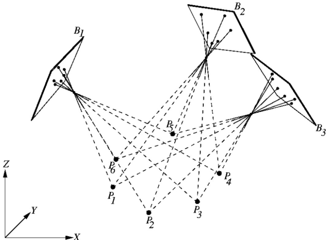
*Slika 3.3. Određivanje točaka objekta  $P_i$  trianguliranjem*
