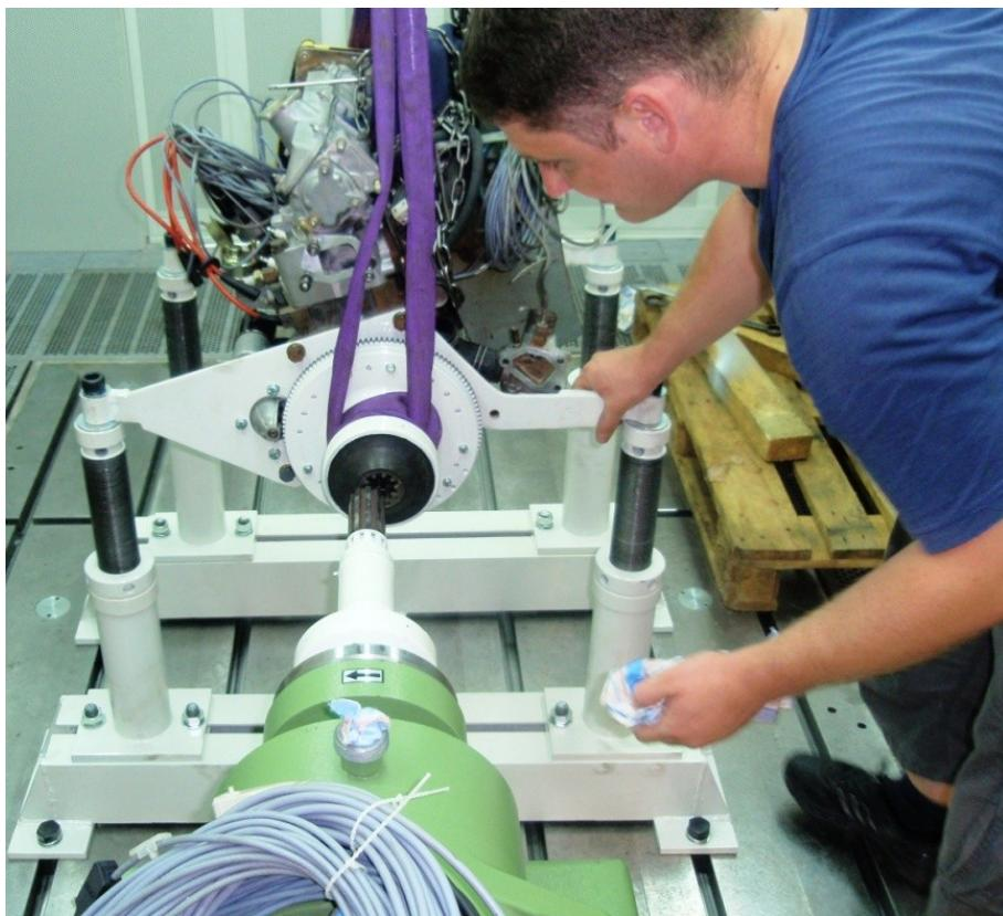
*Slika 4.4. Montaža nosača motora i centriranje ispitnog motora*
