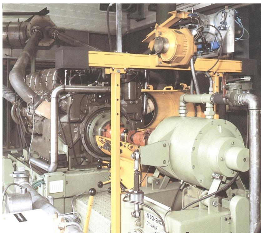
*Slika 2.3. Ispitni motor spojen na hidrauličku kočnicu [2]*
