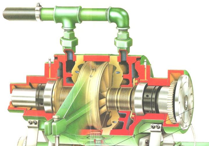
Slika 2.1. Pogled u unutrašnjost hidrauličke kočnice SCHEINCK [2]
