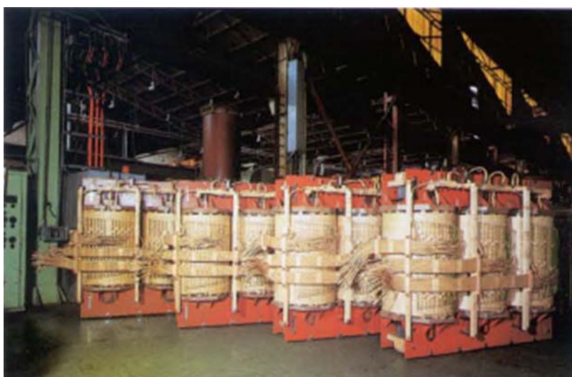
Slika 3. Energetski transformatori – jezgre s namotima
