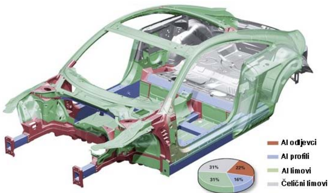
Slika 6.2 Udio čeličnih i aluminijskih dijelova na Audiju TT [49]
