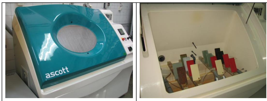
Slika 44. Ispitivanje u slanoj komori [20]
