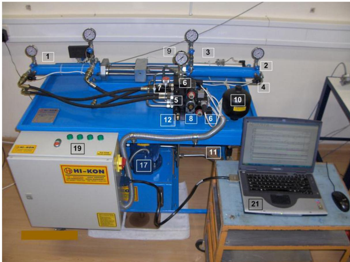
1–pogonski cilindar, 2–cilindar za terećenje, 3–mjerni sustav, 4–senzor tlaka, 5–proporcionalni ventil, 6–elektromagnetski ventil 4/3, 7–prigušni ventil, 8–tlačni regulacijski ventil, 9–manometar, 10–hidraulički akumulator, 11–kuglasta slavina, 12–sigurnosni ventil, 13–rasteretni ventil, 14–tlačni filter, 15–nepovratni ventil, 16–povratni filter, 17–elektromotor, 18–zupčasta crpka, 19–električno sučelje, 20–električni ispravljač, 21–upravljačko računalo s akvizicijskom karticom
