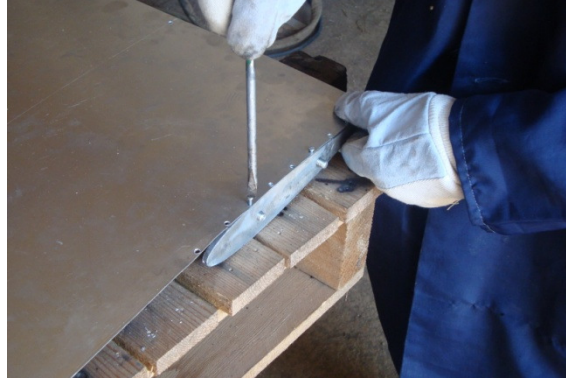
Slika 4. a) Izgled unutarnje konstrukcije krila, b) savijanje oplata preko rebara, c) pričvršćivanje oplata pomoću vijaka
