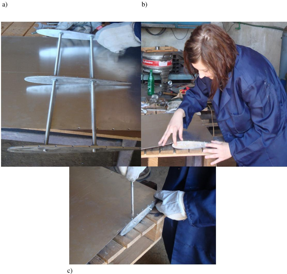
**Slika 4.** a) Izgled unutarnje konstrukcije krila, b) savijanje oplate preko rebara, c) pričvršćivanje oplate pomoću vijaka
